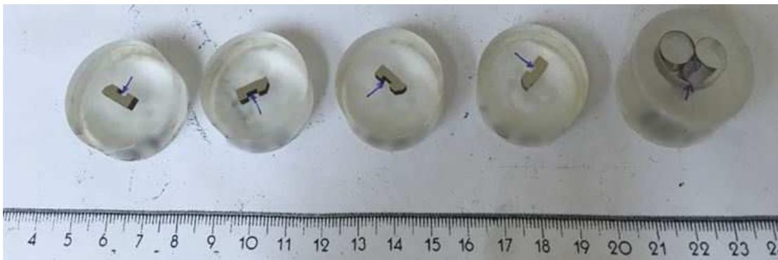
**Slika 26.** Nitrokarburirani uzorci pripremljeni za ispitivanje
