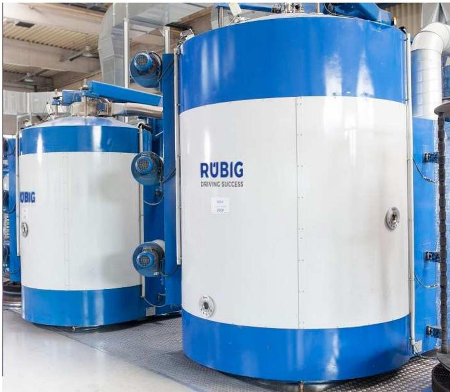
**Slika 8.** Vakuumska komora za postupak PLASOX [14]
