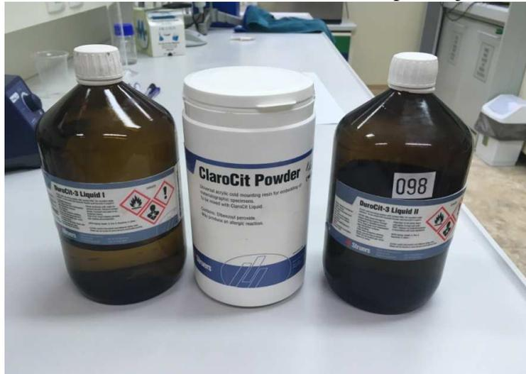
**Slika 16.** Polimerna masa za zalijevanje uzoraka
