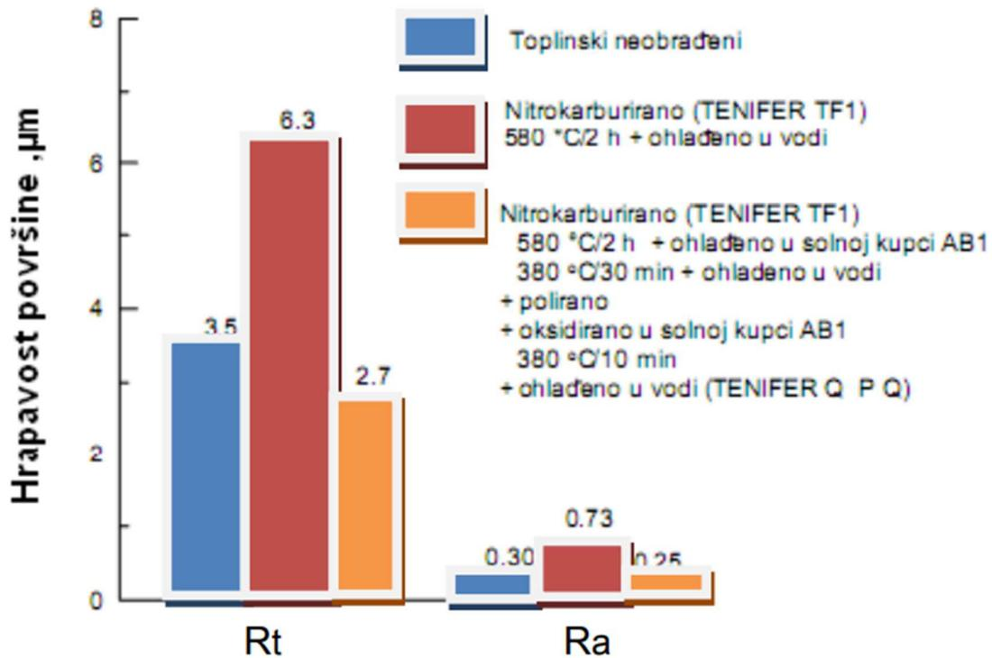
Slika 13. Parametri hrapavosti površine [7]
