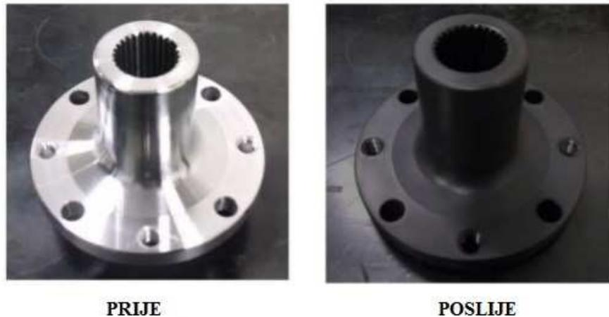
**Slika 9.** *Obradak prije i poslije nitrokarburiranja PLASOX postupkom [15]*
