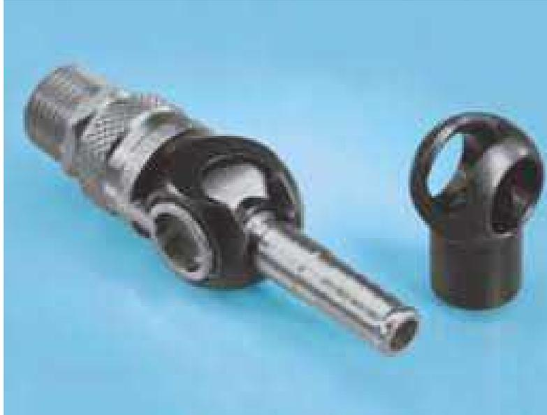
**Slika 14.** *Spojnice nakon nitrokarburiranja TENIFER postupkom [10]*
