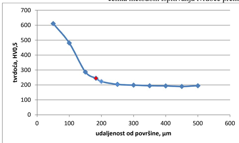
**Slika 31.** Ovisnost tvrdoće udaljenosti od površine za uzorak 2
