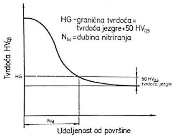
**Slika 29.** Mjerenje nitrokarburiranog sloja mikrotvrdoćom prema Vickersu [2]
