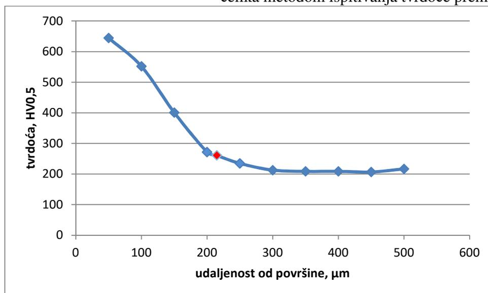
**Slika 30.** Ovisnost tvrdoće udaljenosti od površine za uzorak 1
