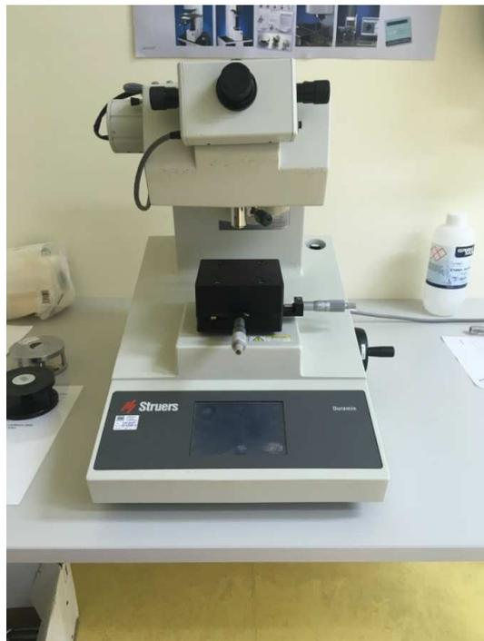
**Slika 21. Uređaj za ispitivanje mikro- i semimikro- tvrdoće prema Vickersu, Struers
