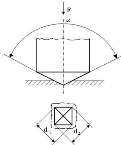
**Slika 22. Princip mjerenja [20]**
