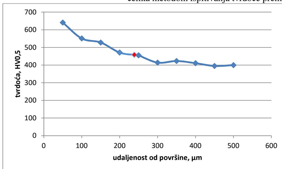
**Slika 33.** Ovisnost tvrdoće udaljenosti od površine za uzorak 4
