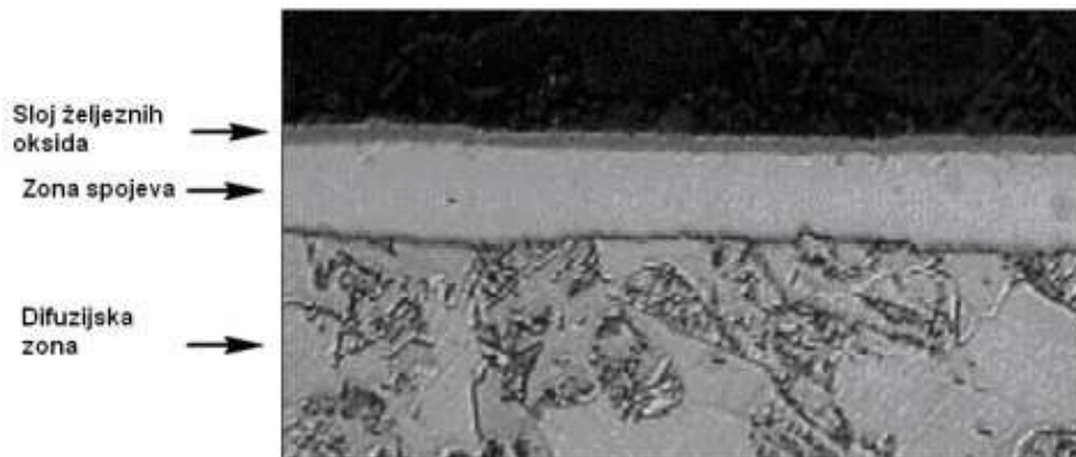
Slika 7. Površinski sloj nakon postupka COLOURNITE i naknadne oksidacije [6]
