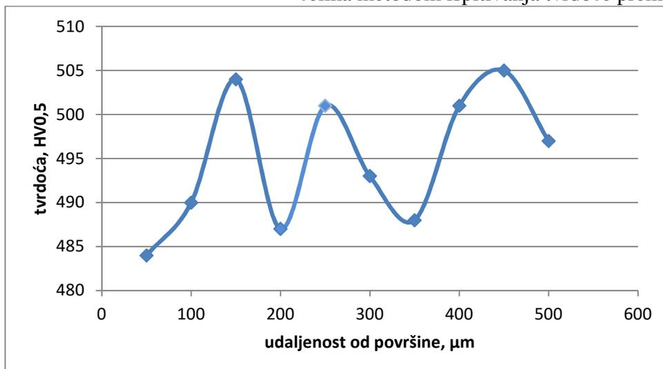
**Slika 34.** Ovisnost tvrdoće udaljenosti od površine za uzorak 5
