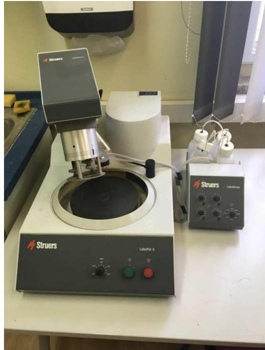
**Slika 17.** Uređaj za brušenje i poliranje Struers LaboPol-5
