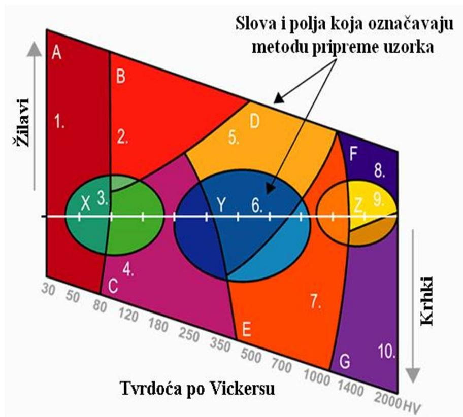
Slika 18. Metalogram za pripremu uzoraka [18]
