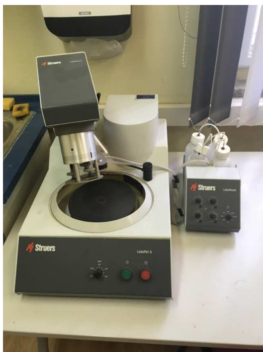
Slika 17. Uređaj za brušenje i poliranje Struers LaboPol-5
