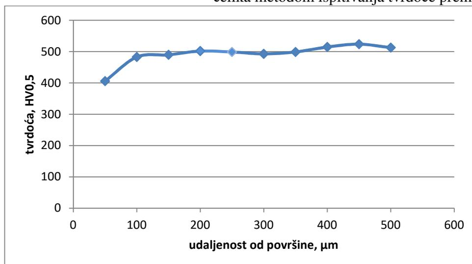
**Slika 32.** Ovisnost tvrdoće udaljenosti od površine za uzorak 3
