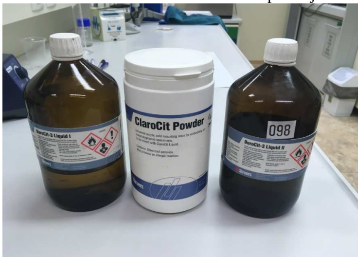
Slika 16. Polimerna masa za zalijevanje uzoraka
