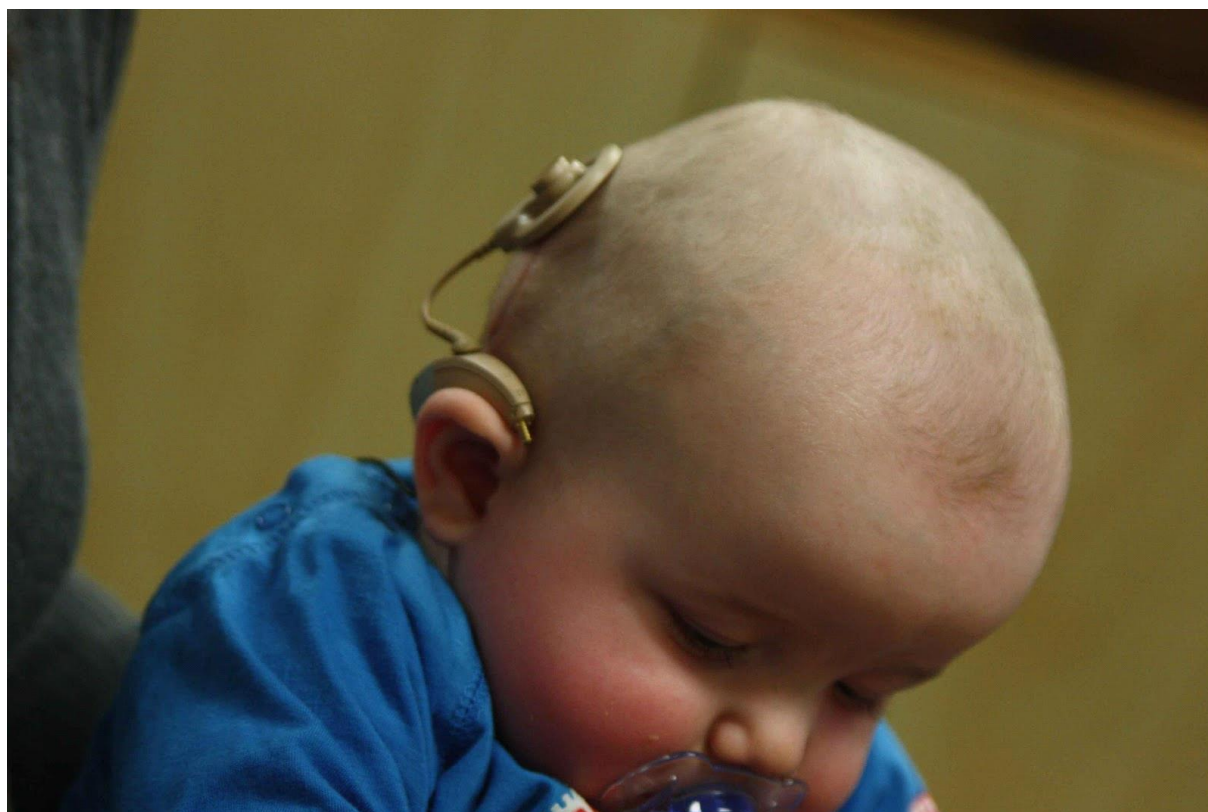
Slika 4. Vanjski dio umjetne pužnice
