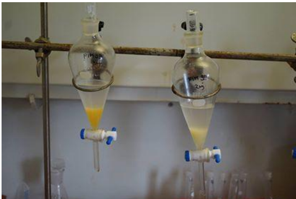
Slika 5. U uzorcima se odvaja organska faza (donja) i voda (gornja) u lijevcima za odjeljivanje
