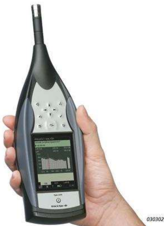
Slika 8 Bruel & Kjar ručni analizator tip 2250
