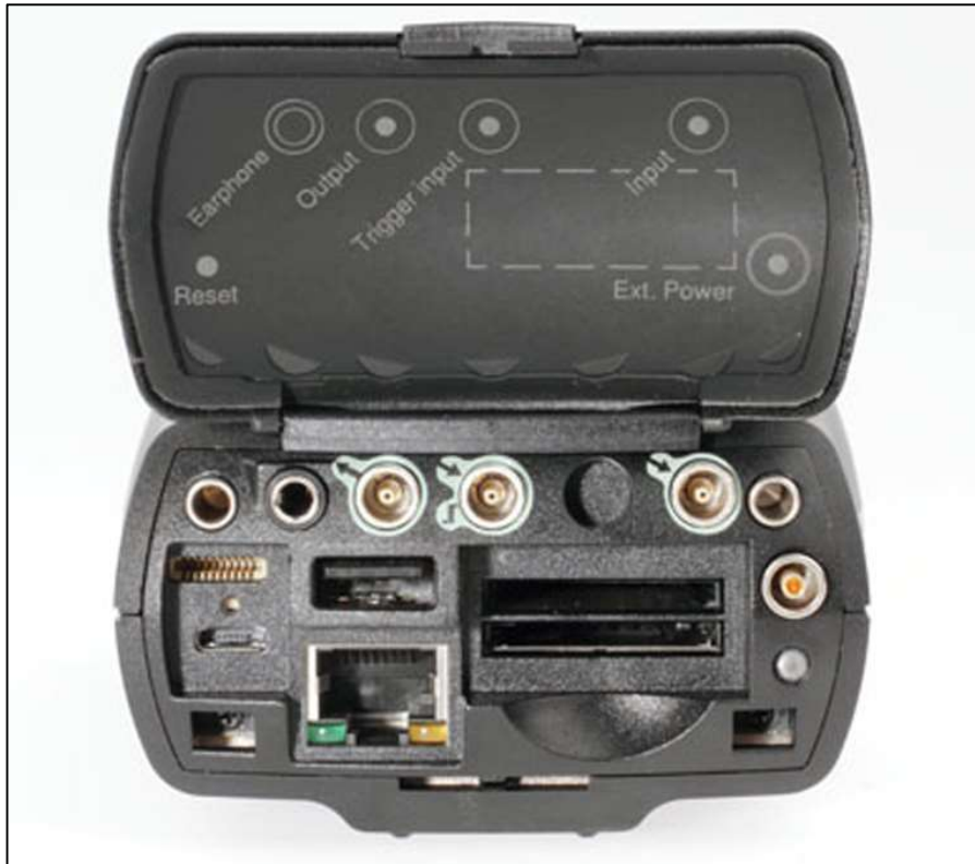
Slika 9 Bruel&Kjaer ručni analizator tip 2250
