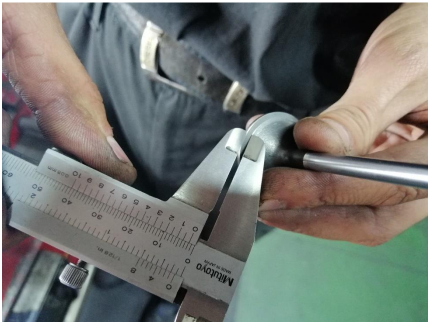
Slika 38 Kontrolna provjera širine ležišta.
