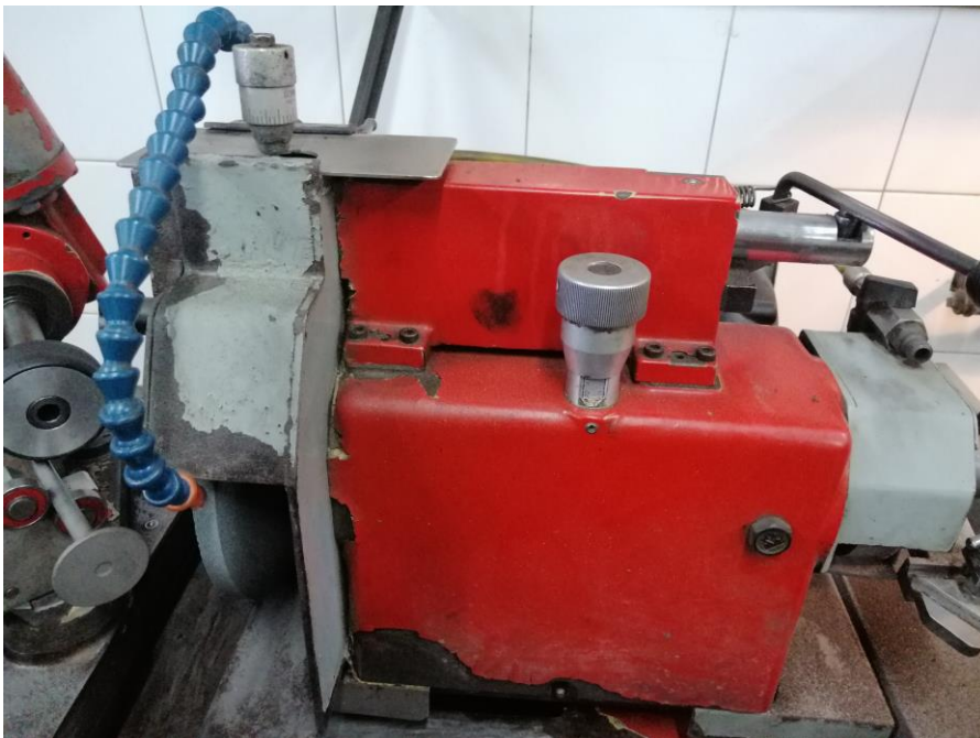
Slika 36 Vidljiv je vijak za namještanje visine obrade ventila
