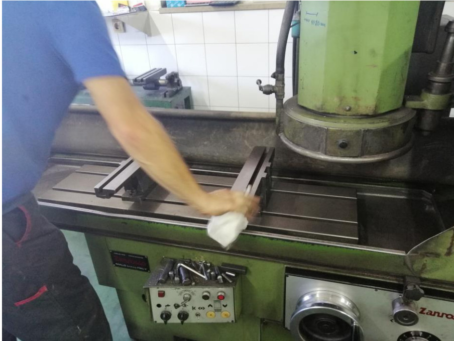
Slika 20 Brisanje radnog stola prije postavljanje glave motora
