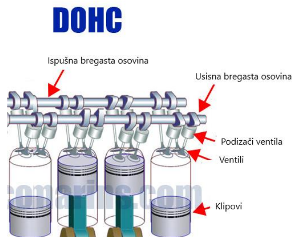
Slika 4 Dijagram DOHC motora
