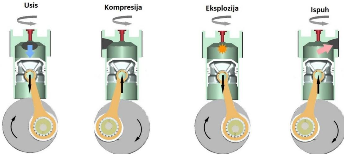
Slika 1 Dijagram četverotaktnog motora s rotirajućim ventilom.
