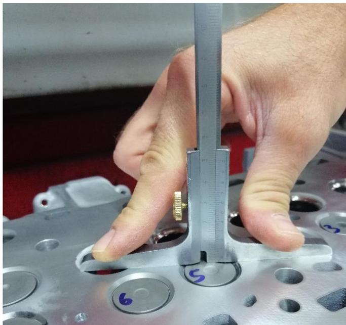
Slika 39 Mjerenje visine ventila u glavi motora
