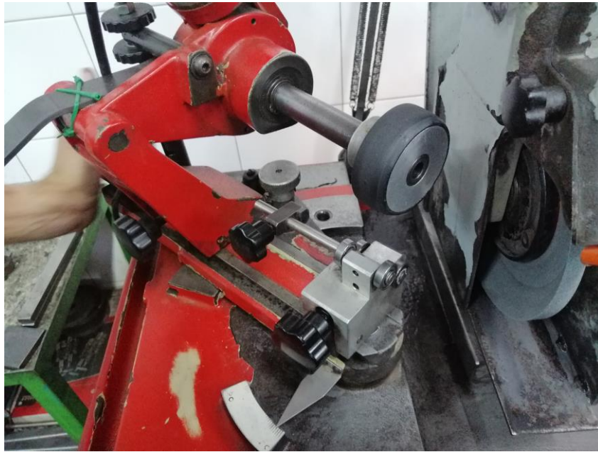
Slika 31 Serdi VR3 s glavom za obradu ventila do 10 mm u promjeru tijela
