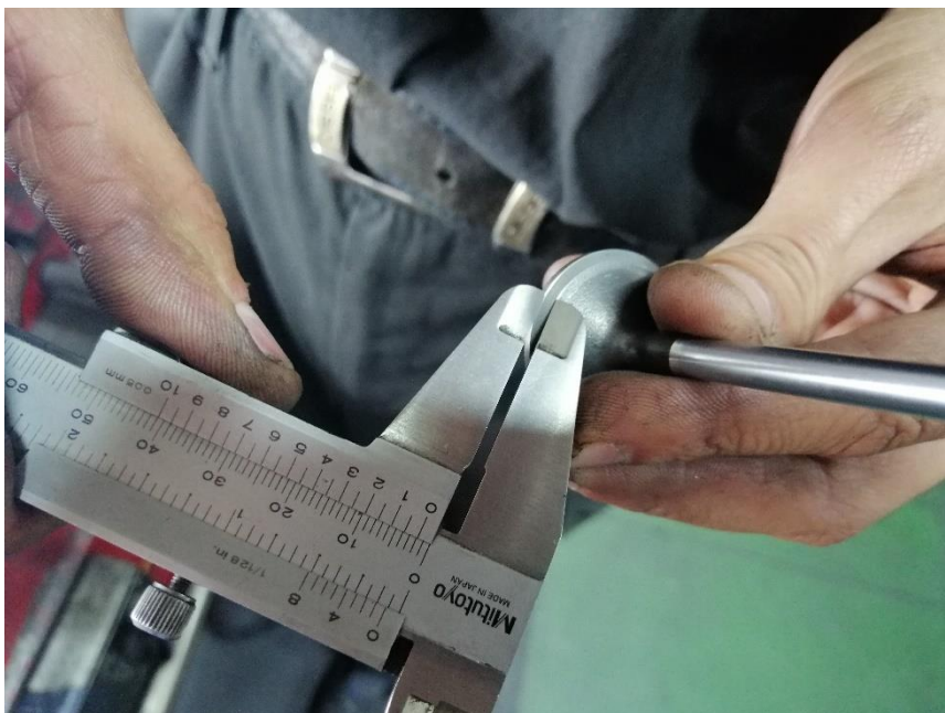
Slika 38 Kontrolna provjera širine ležišta.
