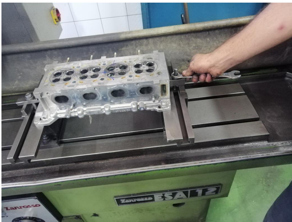
Slika 22 Pričvrščivanje držača na radni stol
