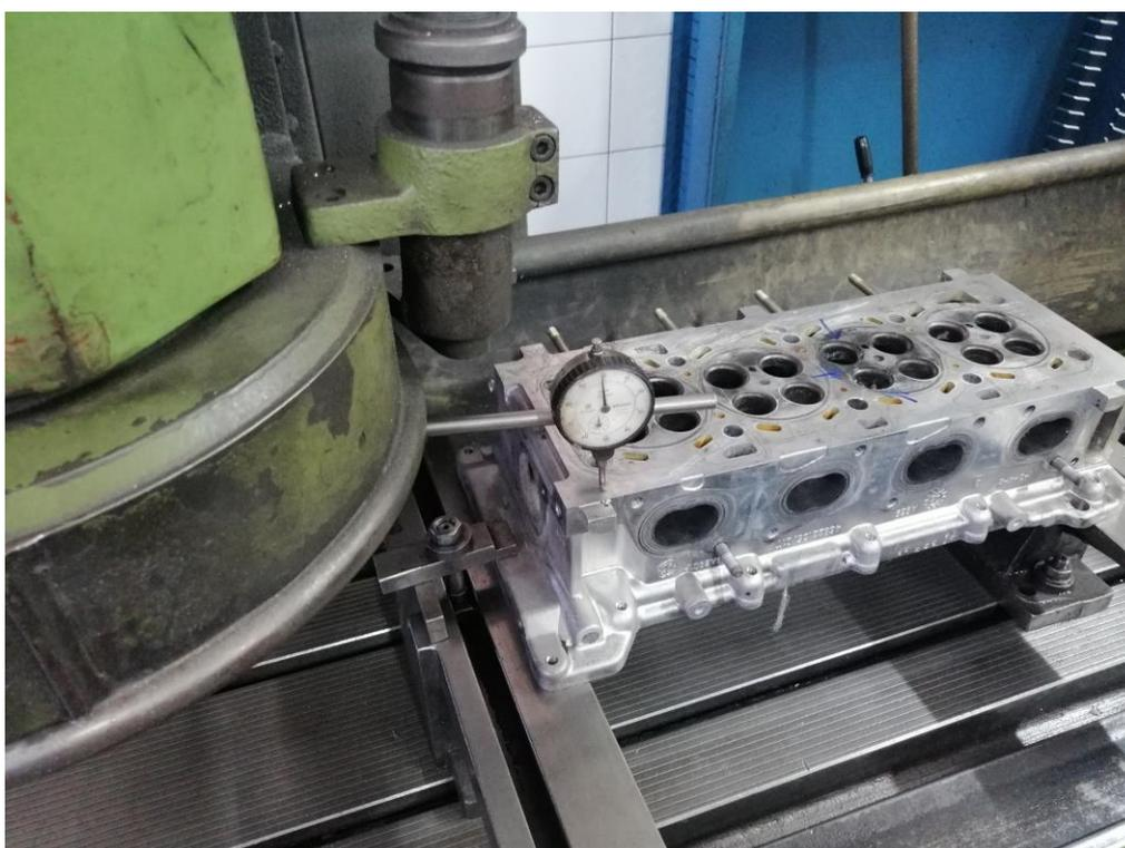
*Slika 23 Određivanje najniže točke glave uz pomoć komparatora.*
