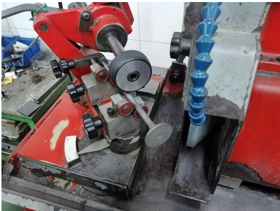
Slika 34 Postavljanje gornjeg, pogonskog kotača na ventil
