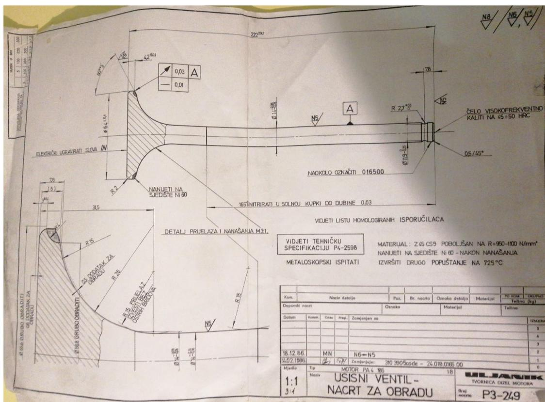
Slika 12 Konstrukcijski nacrt ventila
