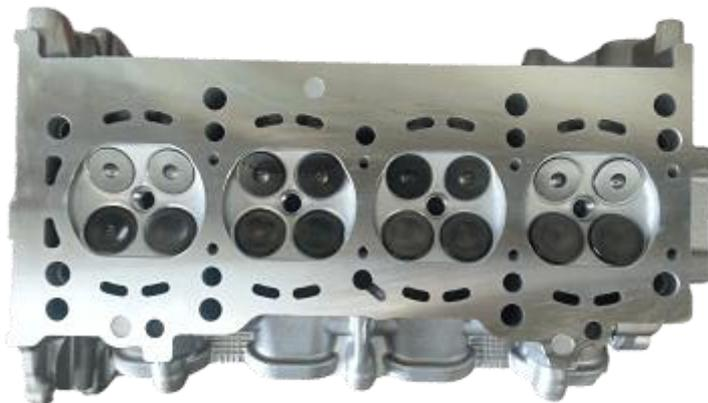
Slika 2 Primjer glave motora s Mazde FS, DOHC motor
