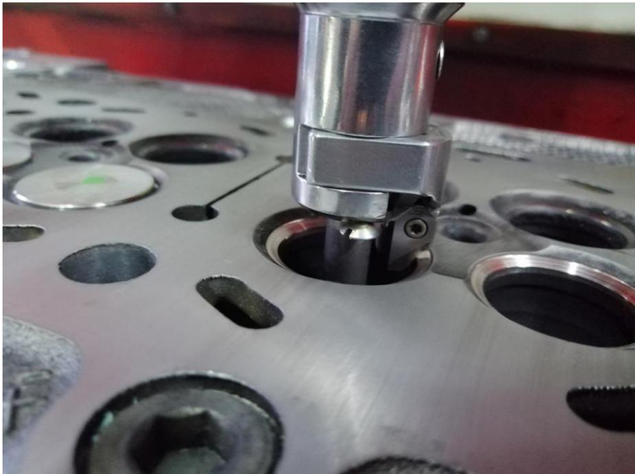
*Slika 29 Nasjedanje noža i pilota unutar sjedišta ventila i njegova obrada*
