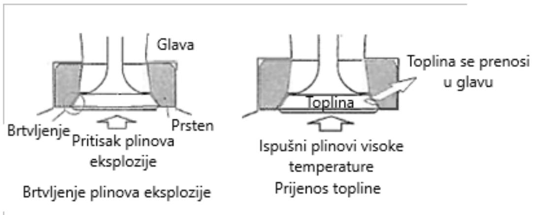
Slika 14 Shematski prikaz glavnih uloga ventila
