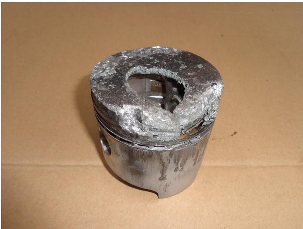
Slika 5 Vidljivo je izgaranje klipa uslijed lošeg ubrizgača Izvor: https://upload.wikimedia.org/wikipedia/commons/5/56/Burnt_piston.JPG [Pristupljeno: 29.6.2019.]
