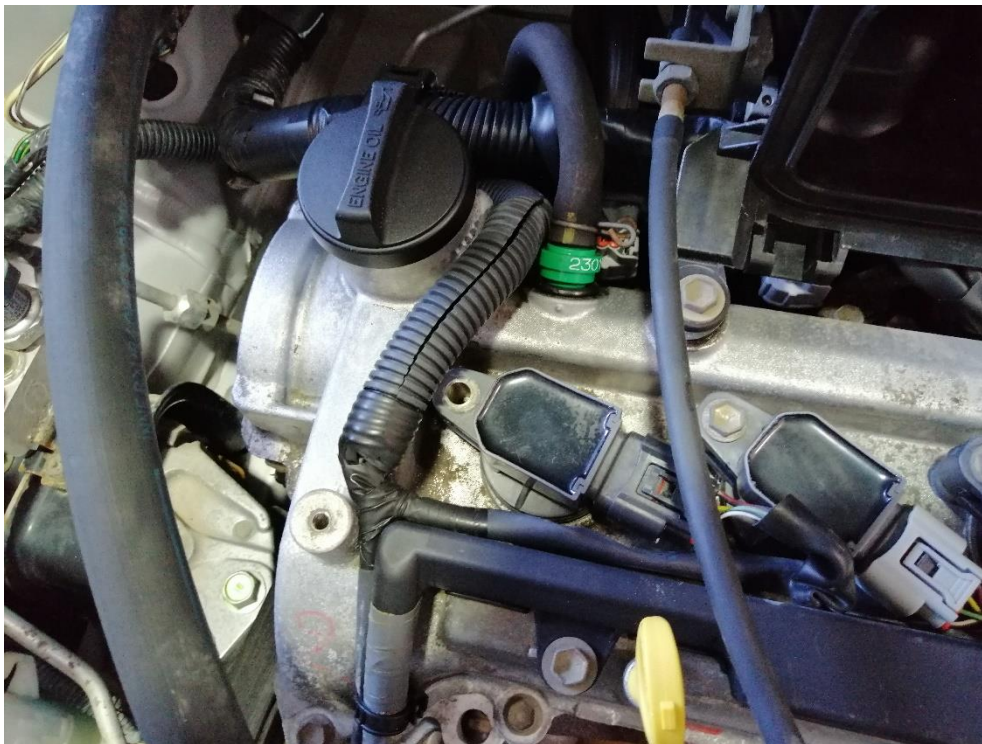
Slika 25 Odvajanje indukcijskog svitka sa svjeće Izvor: Autorska slika
