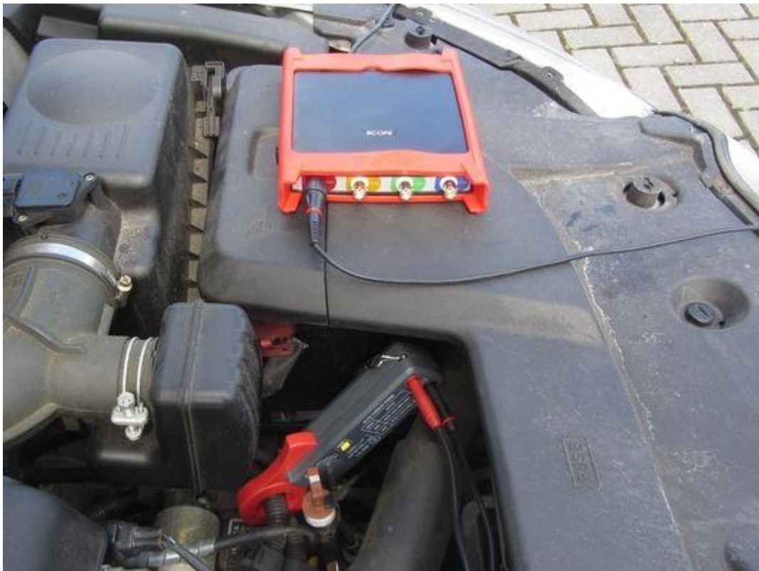
Slika 8 Primjer opreme kakva se koristi kod relativnog testa kompresije Izvor: https://static.tiepie.com/gfx/x400/Automotive/GeneralMeasuring/RelativeCompressionTestMeasurement.jpg [Pristupljeno: 29.6.2019.]
