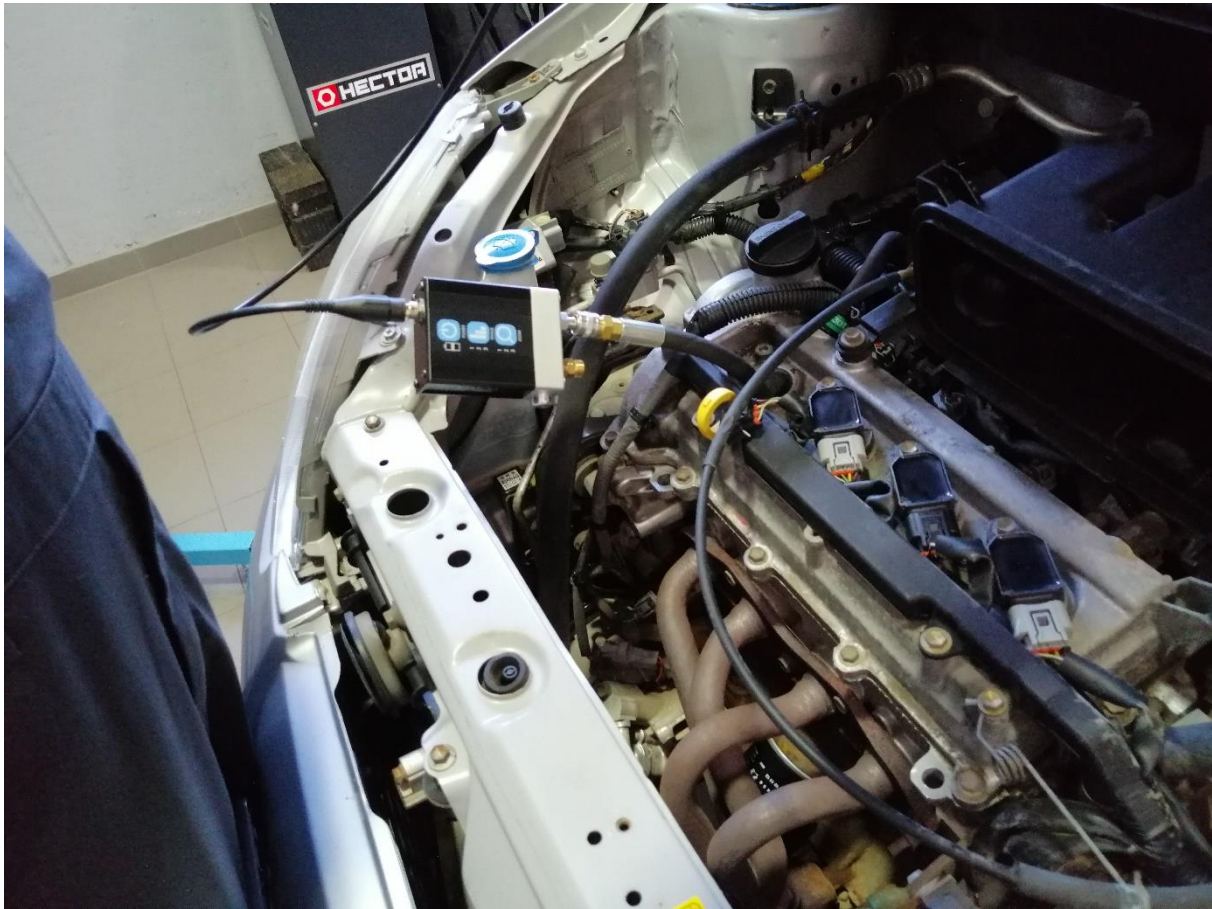
Slika 29 Spojen pretvarač pritiska na mjerno mjesto Izvor: Autorska slika
