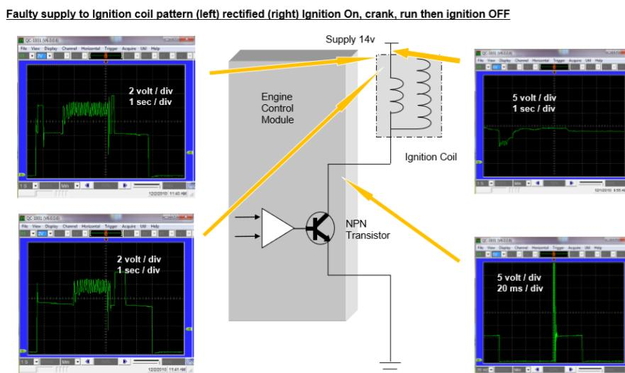
Slika 16 . Prikazuje ispravan (desno) i neisprava (lijevo) signal na rasplinjaču induksijskih svitaka prilikom dijagnostike. Izvor: Nazarian, S.; Stepanian, J.: Oscilloscope waveform Types and interpretation (2012.).
