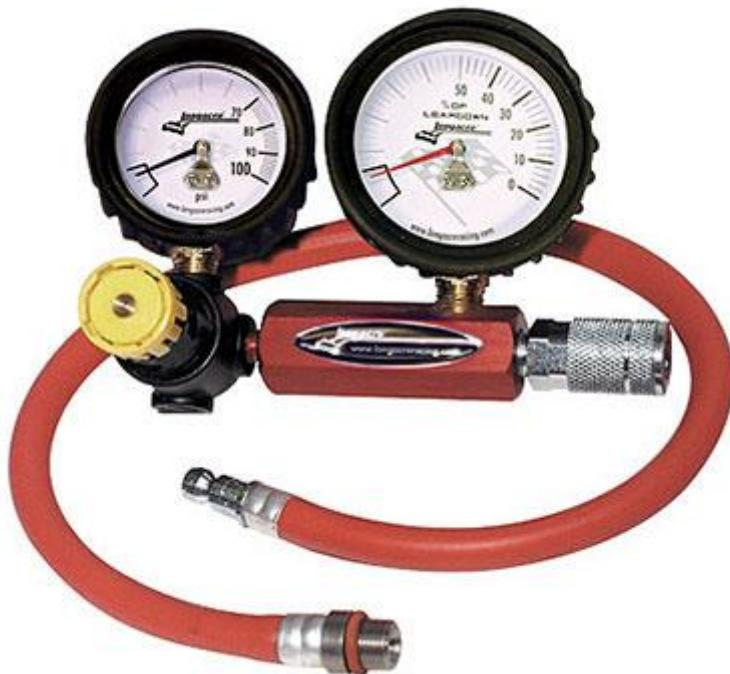
Slika 9 Uredaj za mjerenje kompresije pomoću komprimiranog zraka Izvor:
