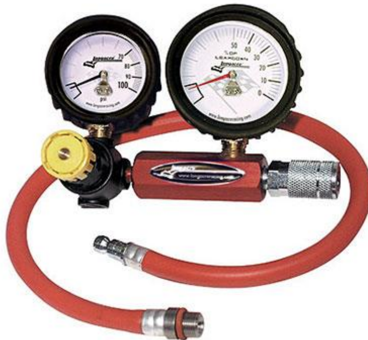
Slika 9 Uređaj za mjerenje kompresije pomoću komprimiranog zraka Izvor: https://www.pegasusautoracing.com/images/L/LA73010.JPG [Pristupljeno: 29.6.2019.]
