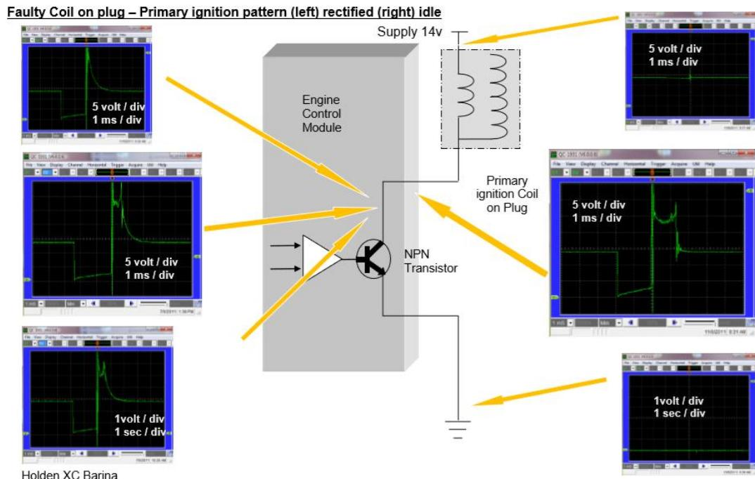
Slika 15 Prikazuje usporedbu neispravnog i ispravnog signala na induksijskom svitku motora. Izvor: Nazarian, S.; Stepanian, J.: Oscilloscope waveform Types and interpretation (2012.).
