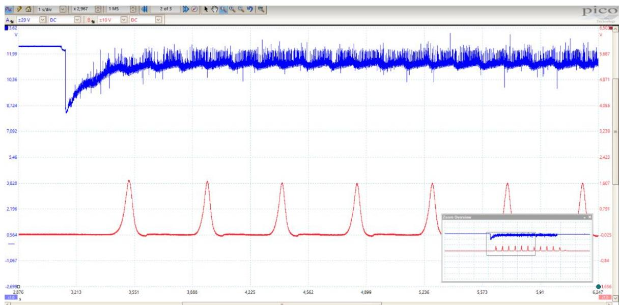
Slika 19 Prikazuje kretanje napona na kanalu A (akumulator) i kretanje napona na kanalu B (pretvaraču pritiska)
