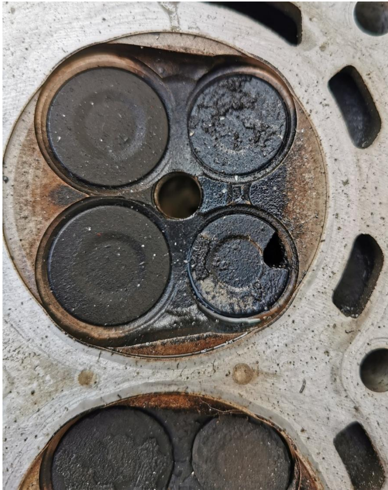
Slika 31 Progorjeli ventil na 4. Cilindru Izvor: Autorska slika
