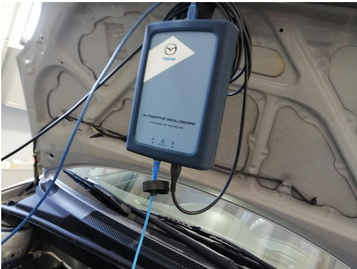
Slika 20 PicoScope 4000 Izvor: Autorska slika
