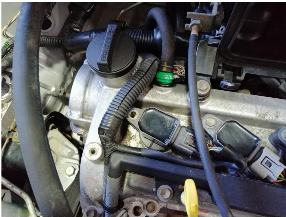
Slika 25 Odvajanje indukcijskog svitka sa svjećice Izvor: Autorska slika
