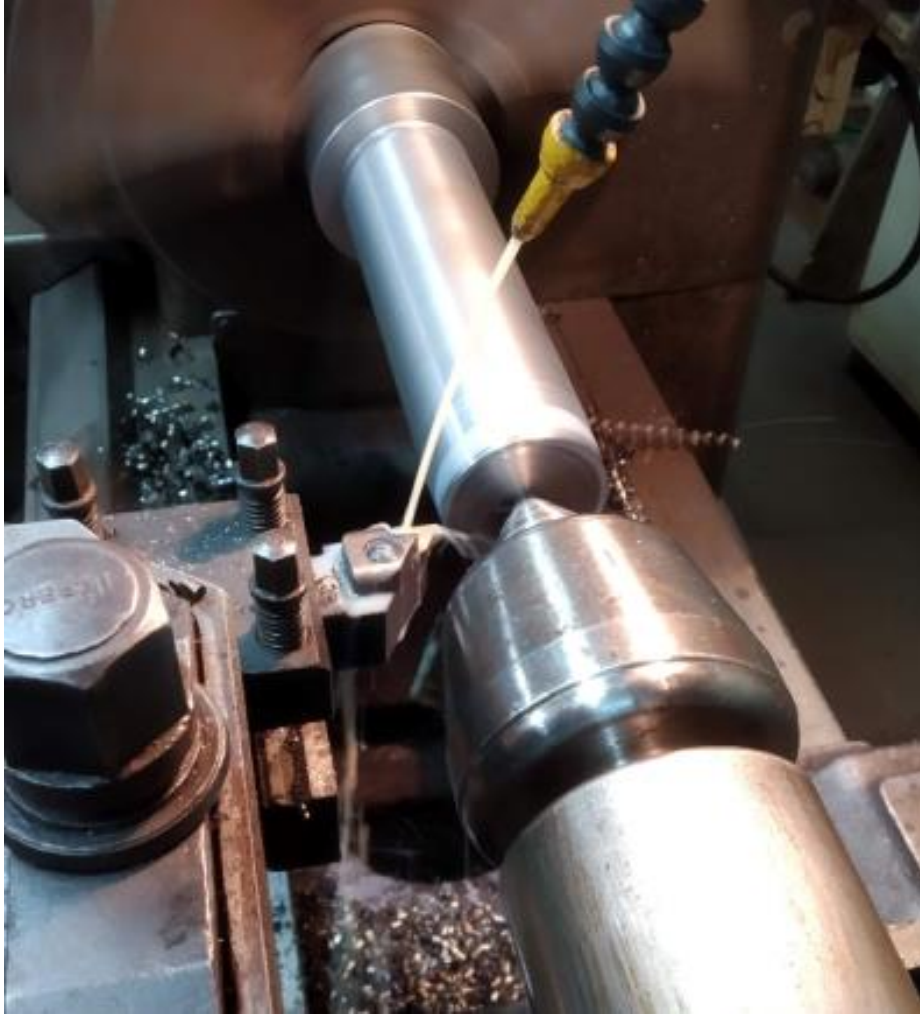
Slika 18. Prikaz emulzije za hlađenje i podmazivanje
