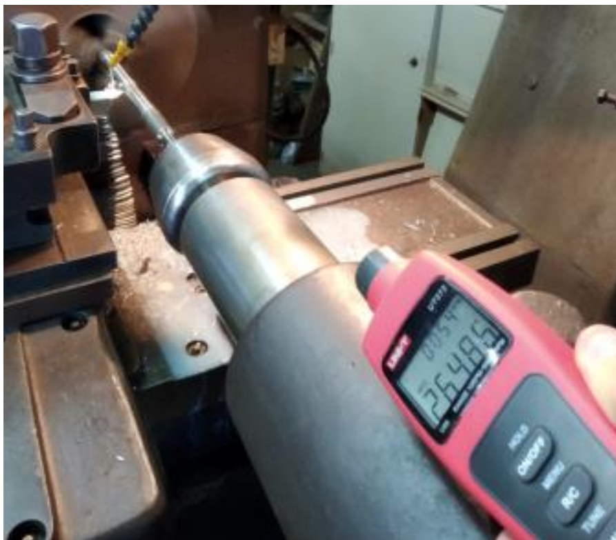
Slika 33. Tahometar mjeri brzinu vrtnje na steznoj glavi
