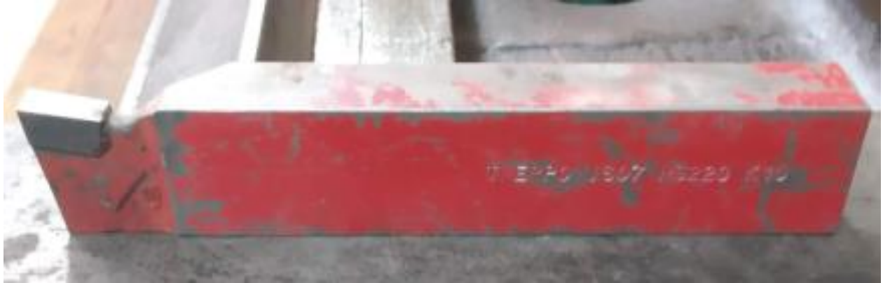
Slika 11. Tokarski nož "Vidia" sa zalemljenom pločicom
