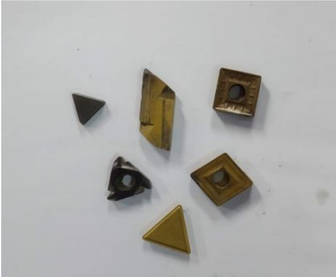
Slika 10. Vrste i oblici pločica za tokarenje
