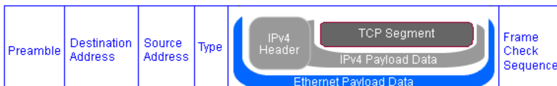
Slika 3. Ethernet okvir obuhvaćajući sloj 3 i iznad sloja 3.
