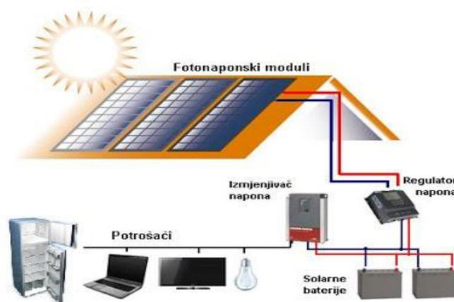
**Slika 2 Samostalni fotonaponski sustav**
