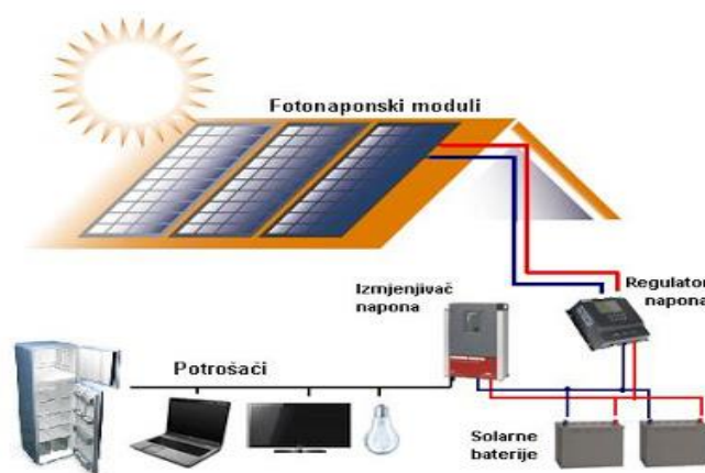
Slika 2 Samostalni fotonaponski sustav
