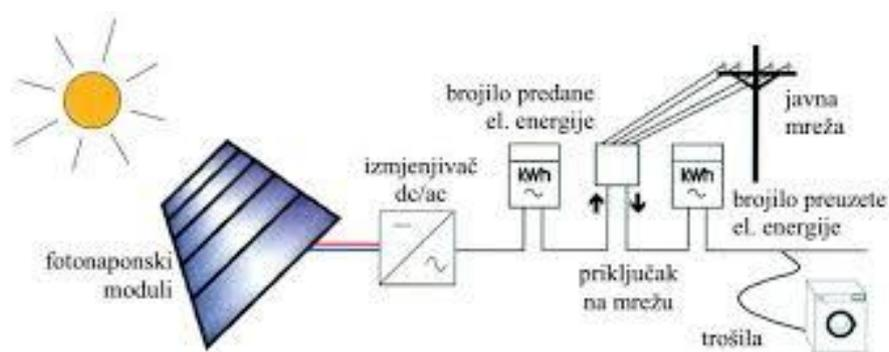
**Slika 1 Fotonaponski sustav vezan na elektroenergetsku mrežu**
