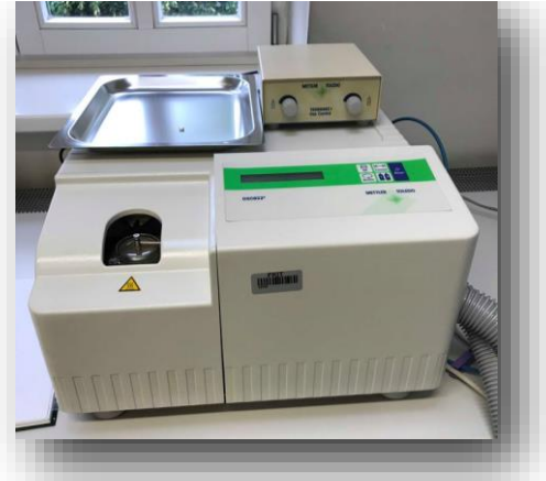
Slika 15. Diferencijalni pretzračni kalorimetar, DSC 822 e , Mettler Toledo
