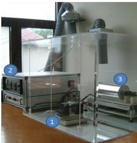
Slika 12. Uređaj za elektroispredanje
