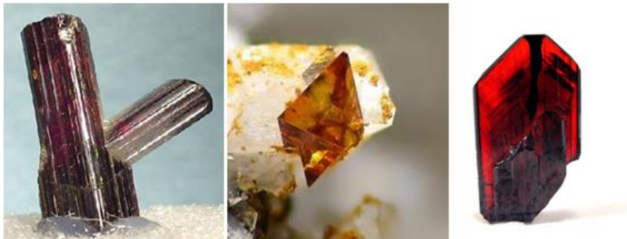
Slika 4. Polimorfne modifikacije \text{TiO}_2 : rutil, anatas, brukit [18]
