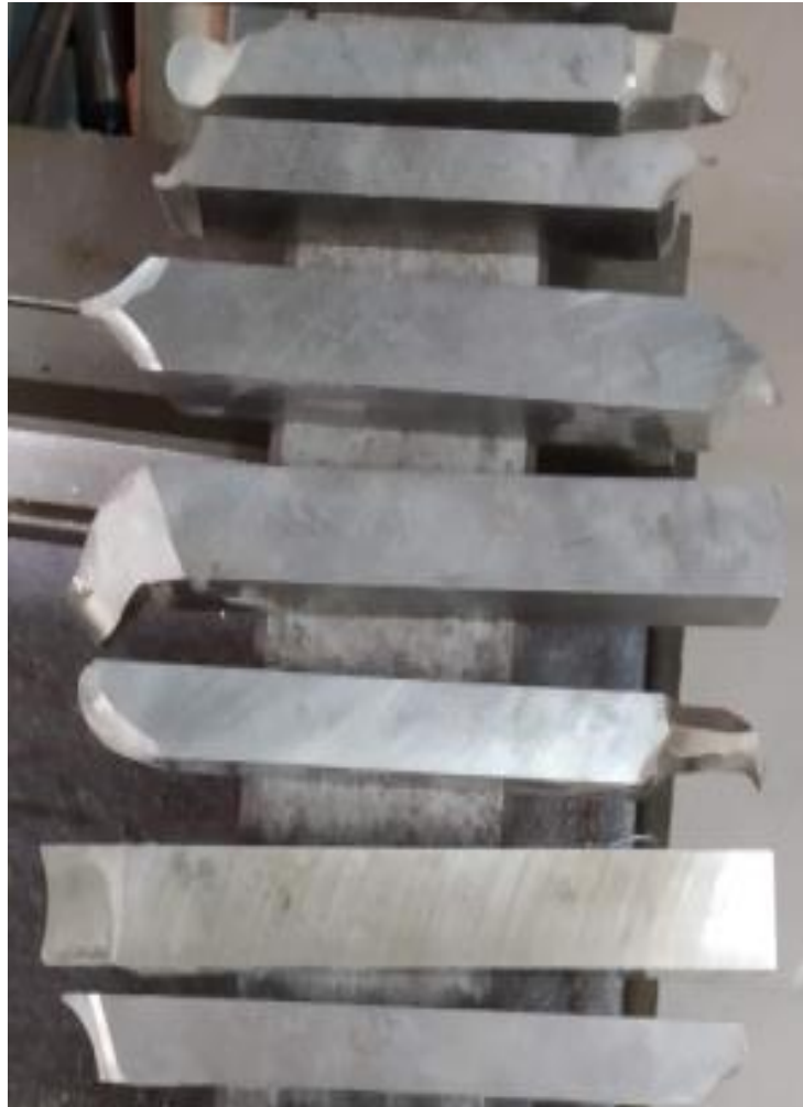
Slika 12. Jednodijelni tokarski noževi "Stirija"
