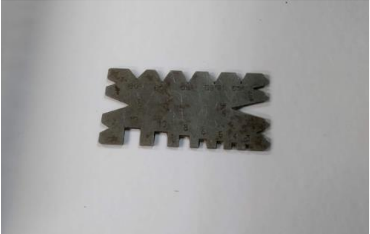
Slika 13. Šablona za kontrolu kuta noža 60° metrički
