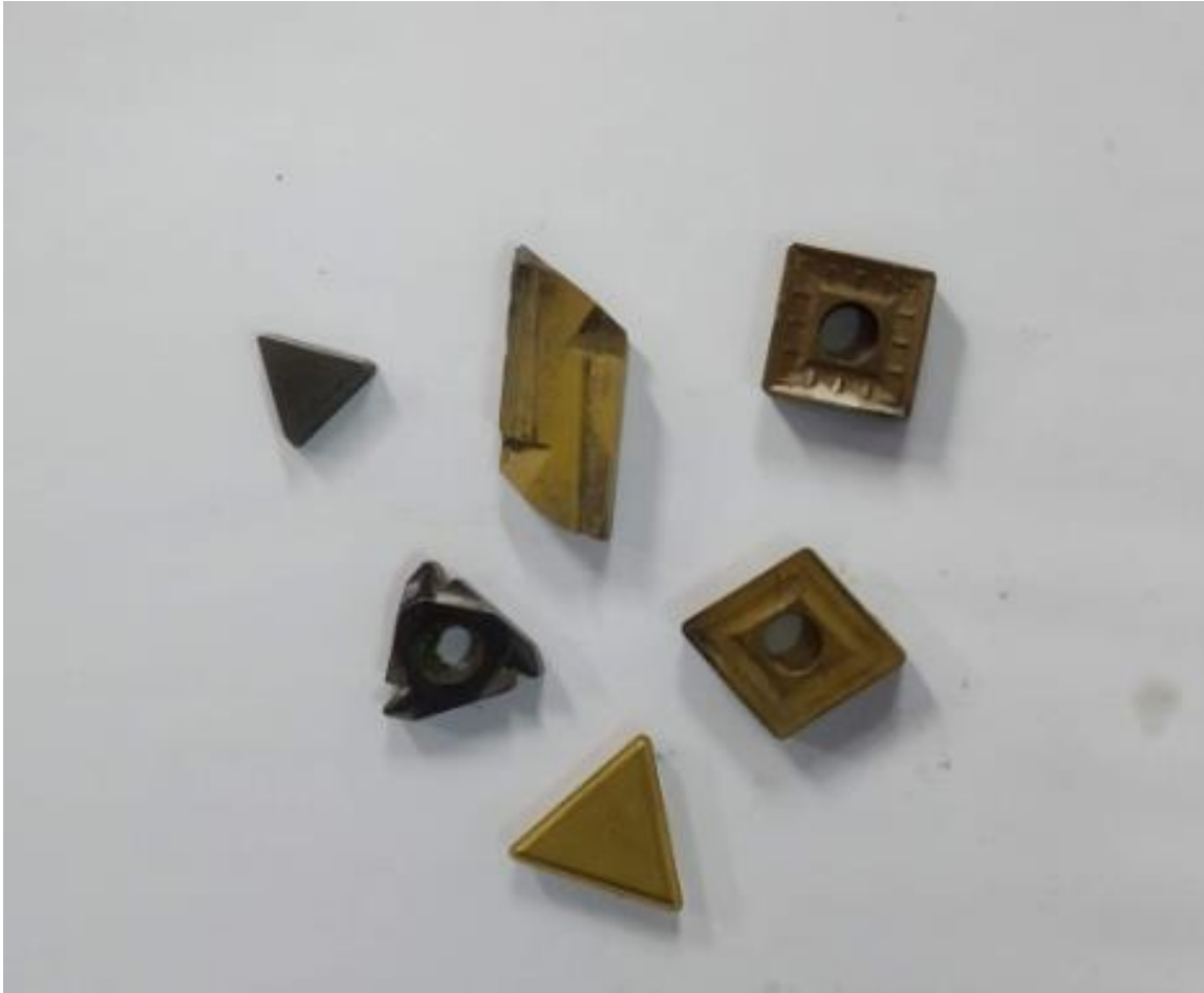
Slika 10. Vrste i oblici pločica za tokarenje
