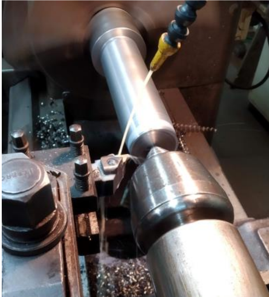
Slika 18. Prikaz emulzije za hlađenje i podmazivanje
