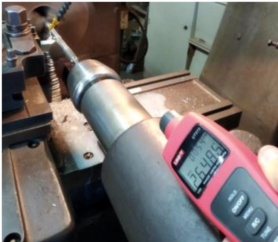
Slika 33. Tahometar mjeri brzinu vrtnje na steznoj glavi
