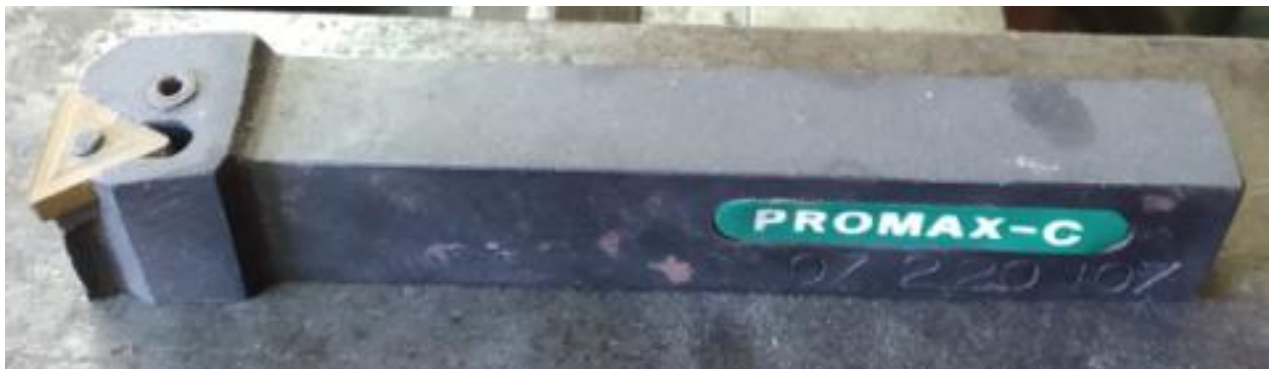
Slika 9. Nož sa pločicom pričvrščenom pomoću vijka
