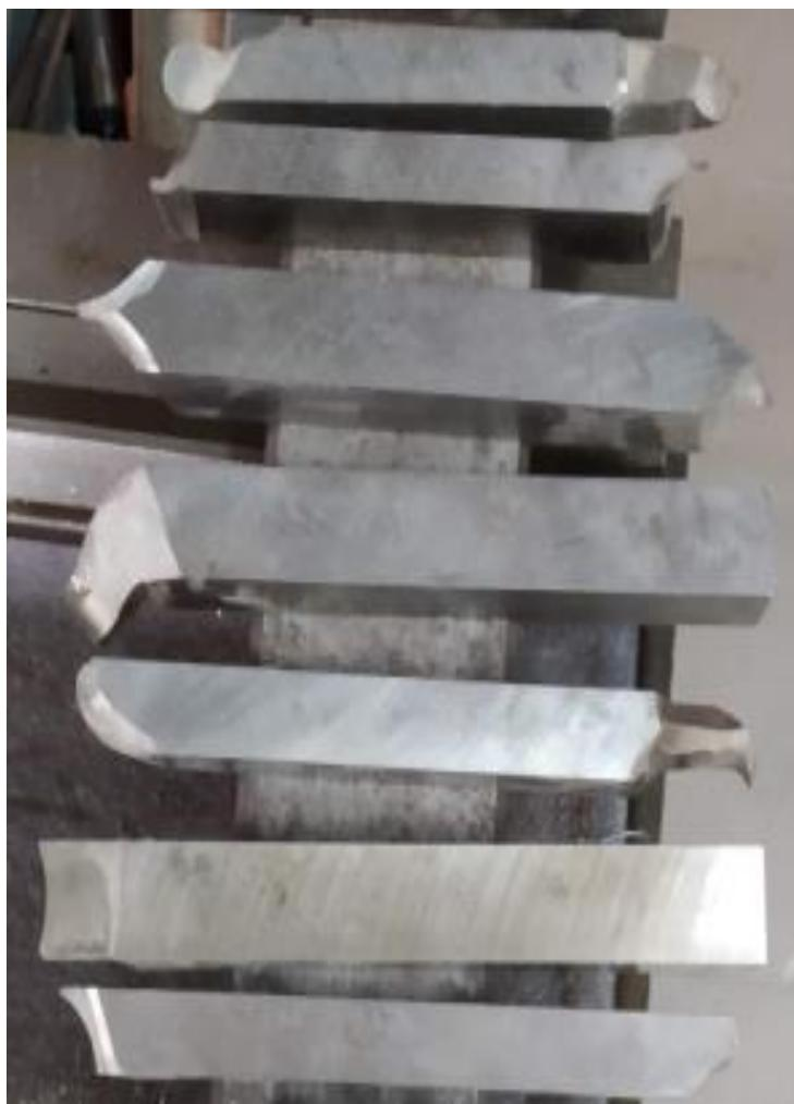
Slika 12. Jednodijelni tokarski noževi "Stirija"
