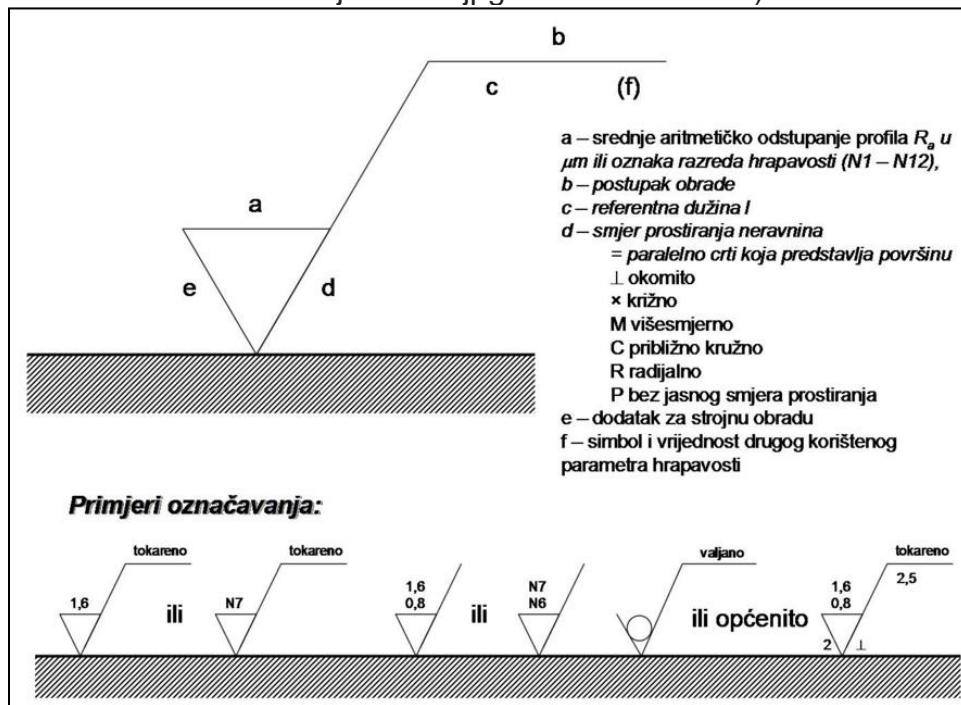
Slika 22. Označavanje hrapavosti površine u radioničkom nacrtu
