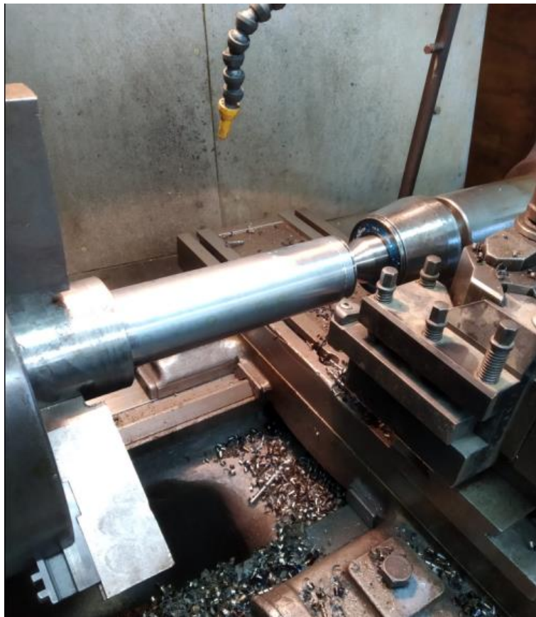
Slika 14. Prikaz komada fiksiranog u dvije točke
