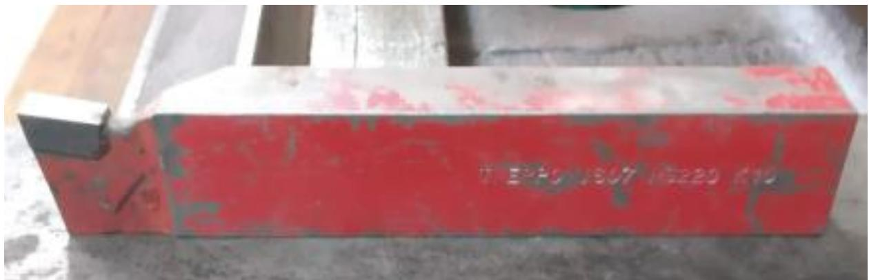
Slika 11. Tokarski nož "Vidia" sa zalemnjom pločicom
