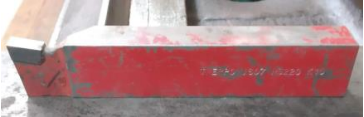
Slika 11. Tokarski nož "Vidia" sa zalemljenom pločicom
