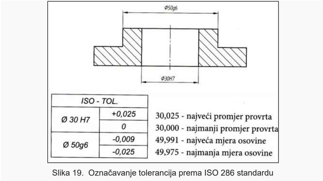
Slika 19. Označavanje tolerancija prema ISO 286 standardu
