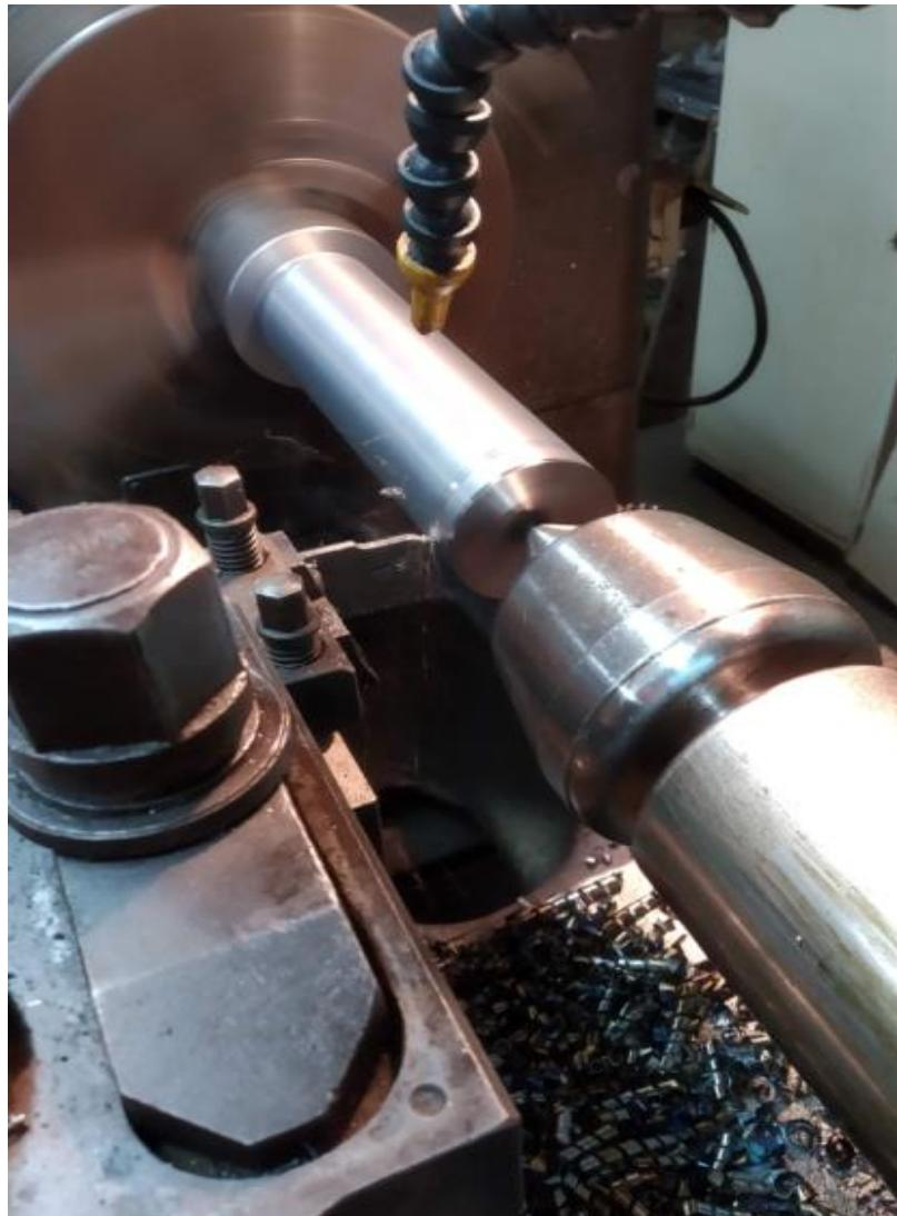
Slika 4. Uzdužno vanjsko tokarenje
