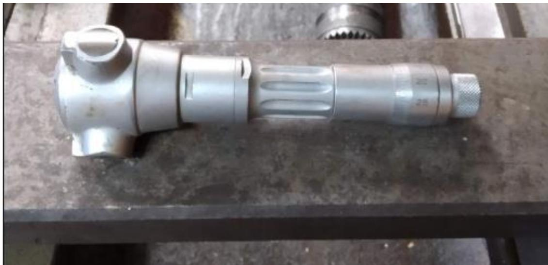
Slika 28. Mikrometar za provrte
