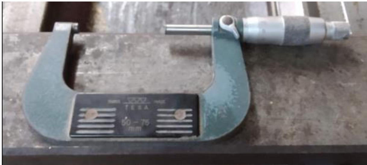
Slika 29. Mikrometar
