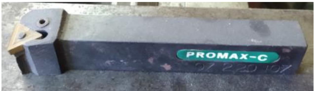
Slika 9. Nož sa pločicom pričvršćenom pomoću vijka
