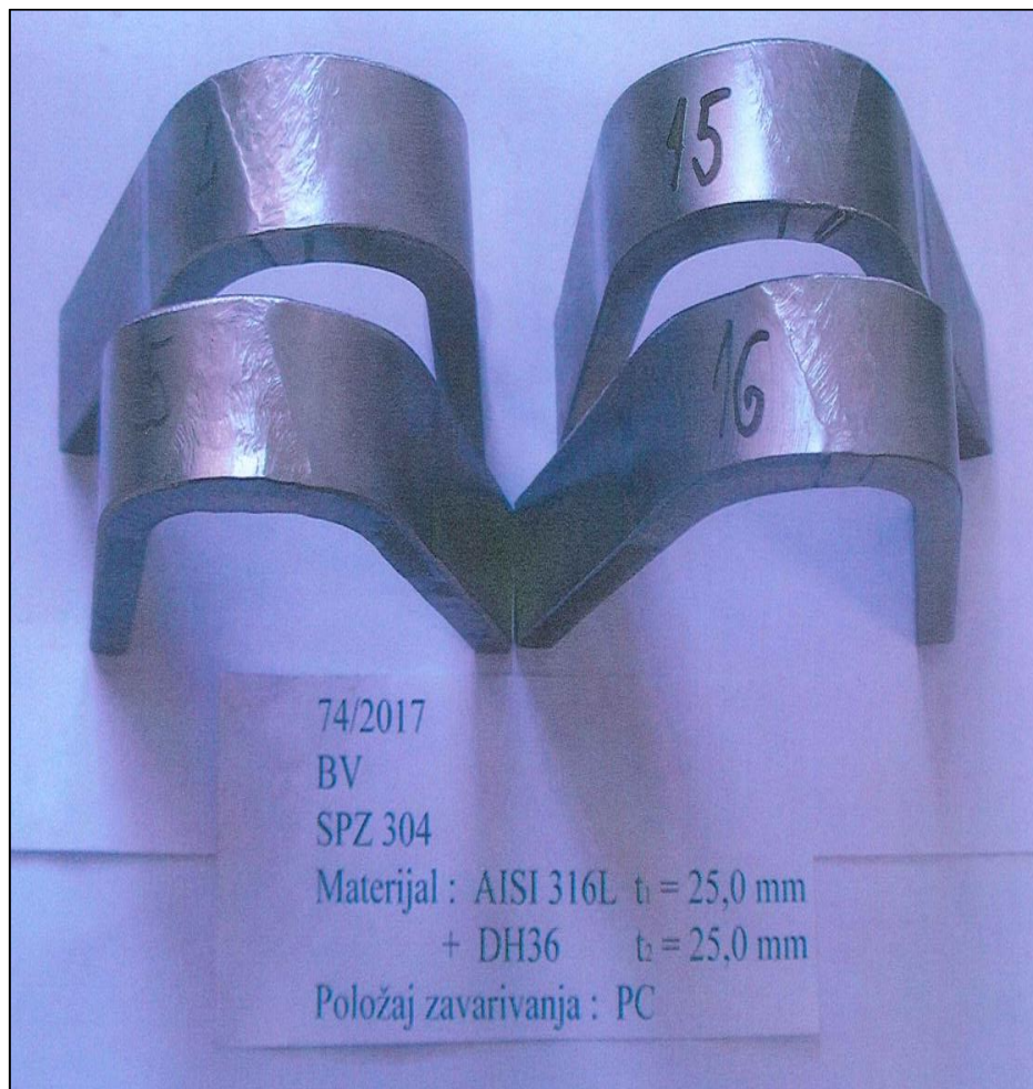
Slika 27 Epruvete nakon ispitivanja savijanjem
