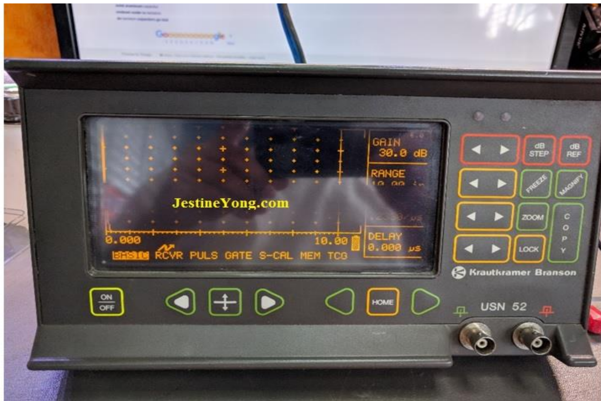
Slika 18 Uređaj za ultrazvuk - Krautkramer USN 52
