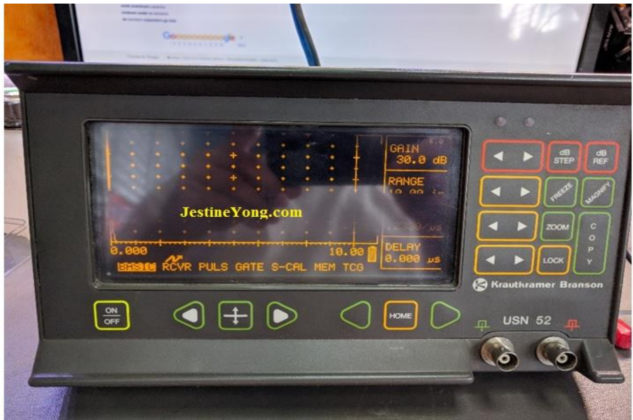
Slika 18 Uređaj za ultrazvuk - Krautkramer USN 52
