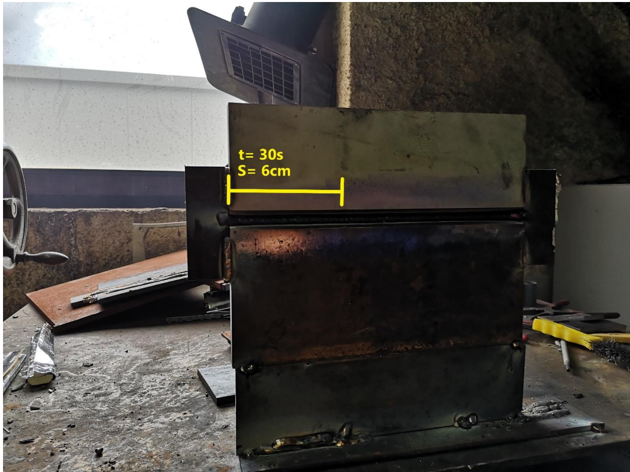
Slika 13 Mjerenje brzine zavarivanja
