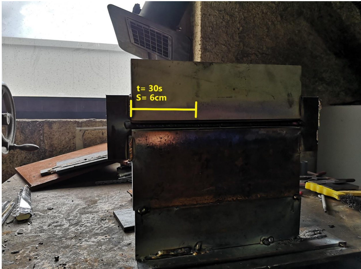
Slika 13 Mjerenje brzine zavarivanja
