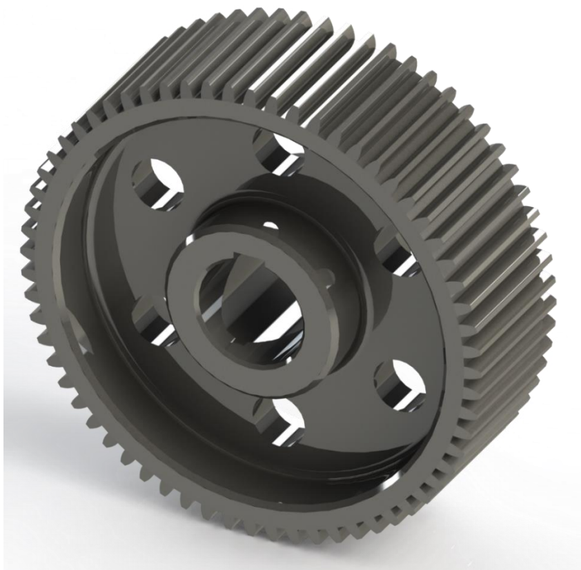
Slika 18 3D model gonjenog zupčanika
