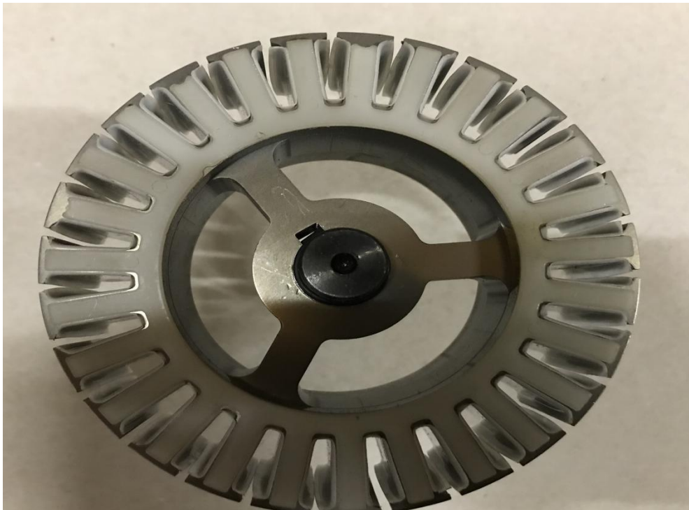
Slika 22: Stator sa postavljenim zaštitama
