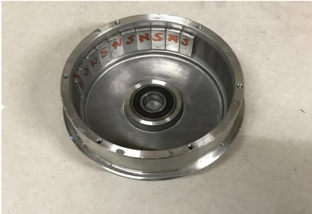
Slika 18: Lijepljenje trajnih magneta
