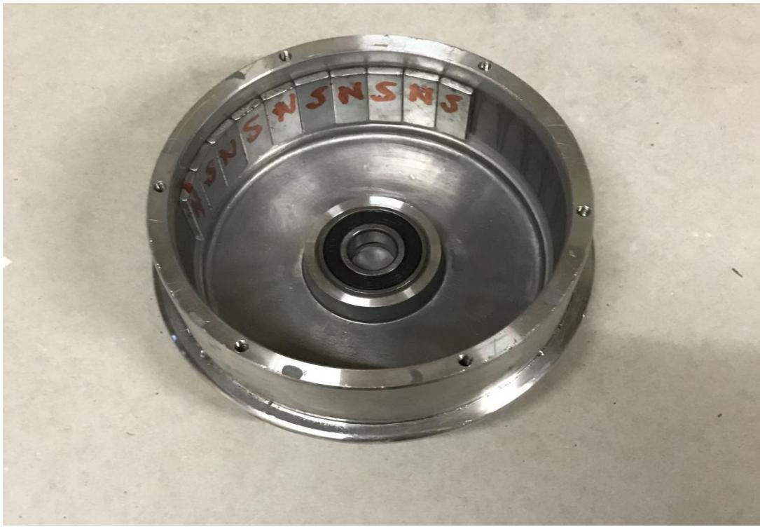
Slika 18: Lijepljenje trajnih magneta
