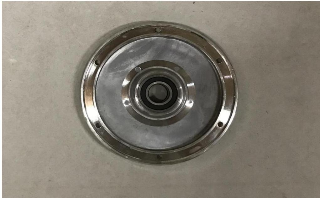
Slika 19: Poklopac kućišta rotora
