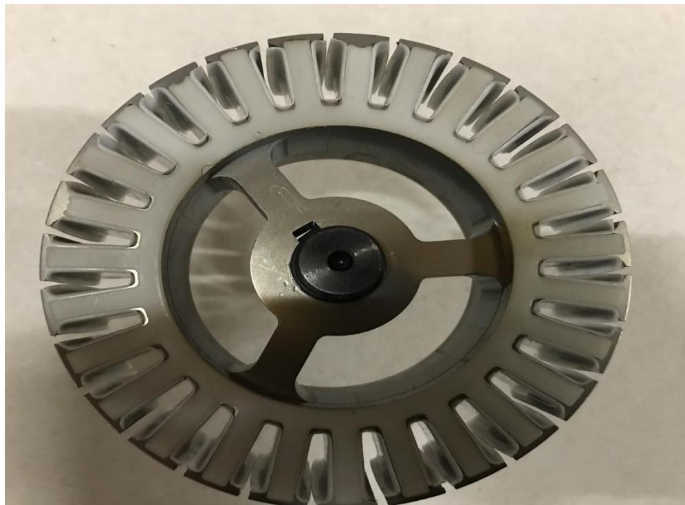
Slika 22: Stator sa postavljenim zaštitama
