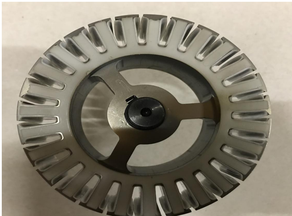
Slika 22: Stator sa postavljenim zaštitama
