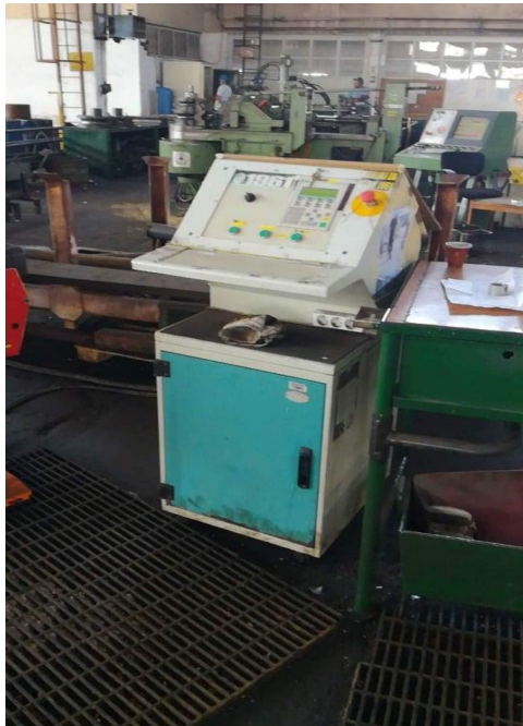
Slika 14. Savijačica Pedrazzoli s trnom, 2.
