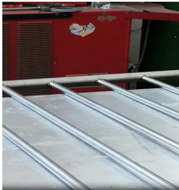
Slika 21. Puntiranje bez dodatka žice
