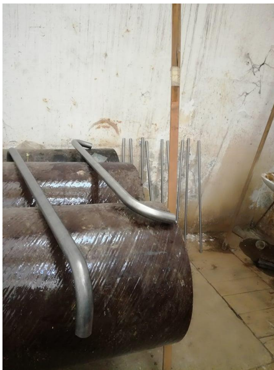
Slika 16. Cijevi nakon faze rezanja i savijanja, 2.
