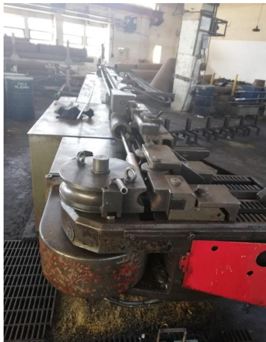
Slika 13. Savijačica Pedrazzoli s trnom, 1.
