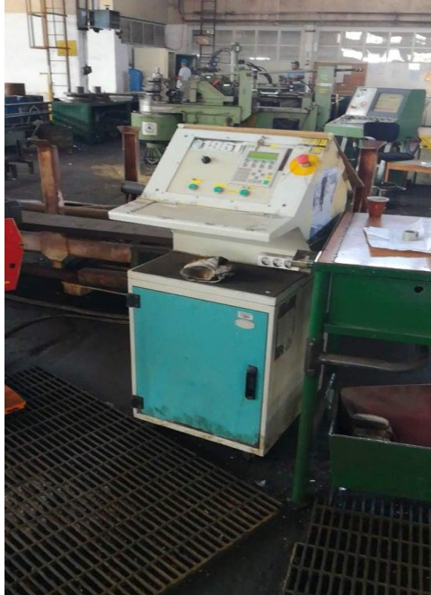
Slika 14. Savijačica Pedrazzoli s trnom, 2.
