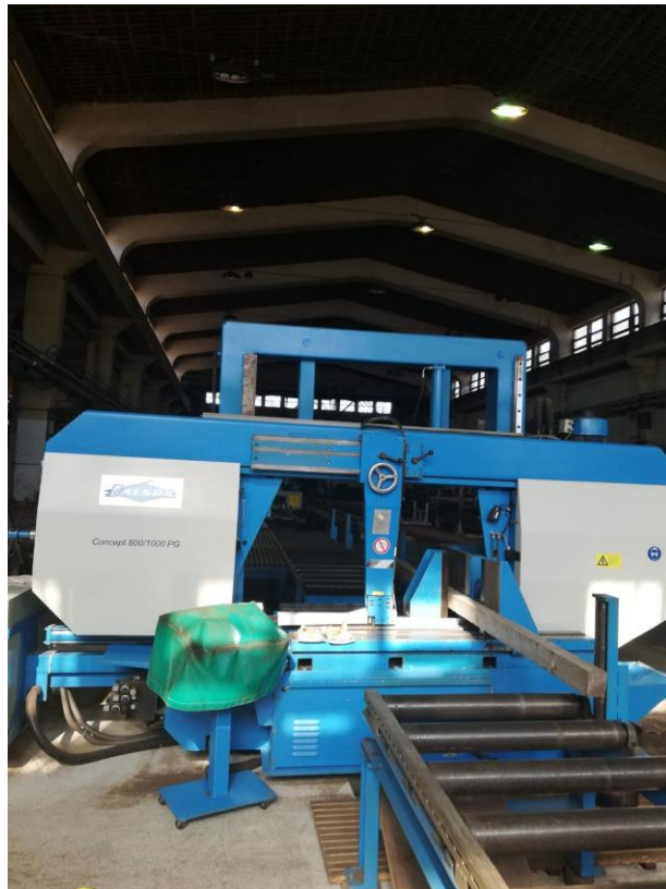
Slika 12. Tračna pila JAESPA 800/1000PG
