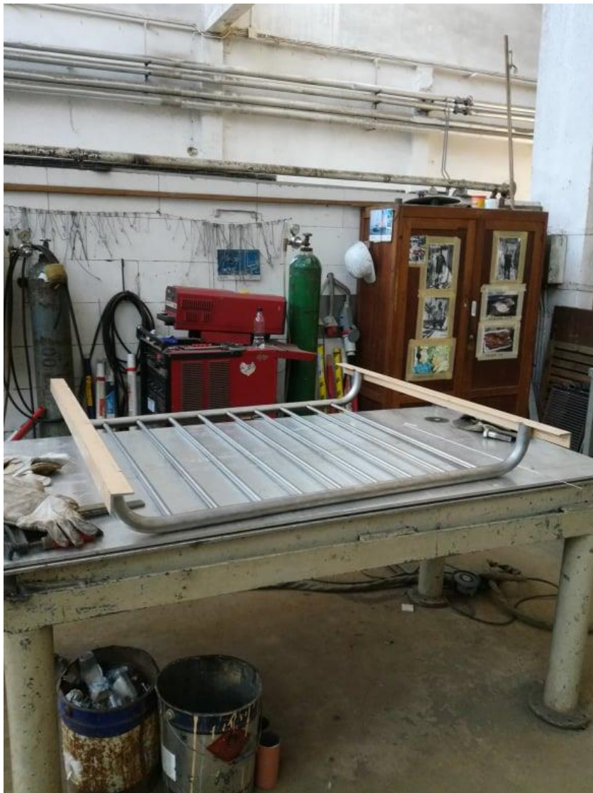
Slika 20. Montirana ograda na L profilima
