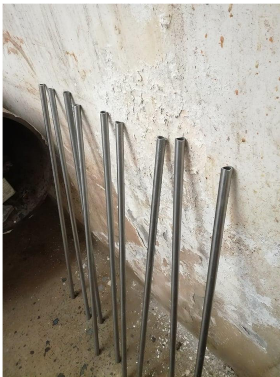
Slika 15. Cijevi nakon faze rezanja i savijanja, 1.
