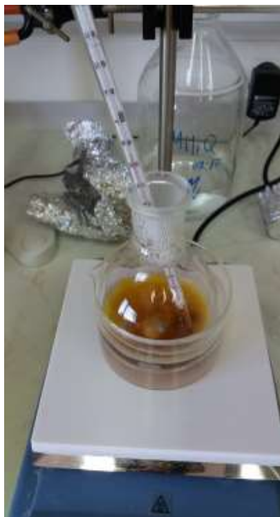
Slika 10. Disperzija nanočestica srebra dobivenih u laboratoriju za morsku nanotehnologiju i biotehnologiju (CIM, Rovinj).
