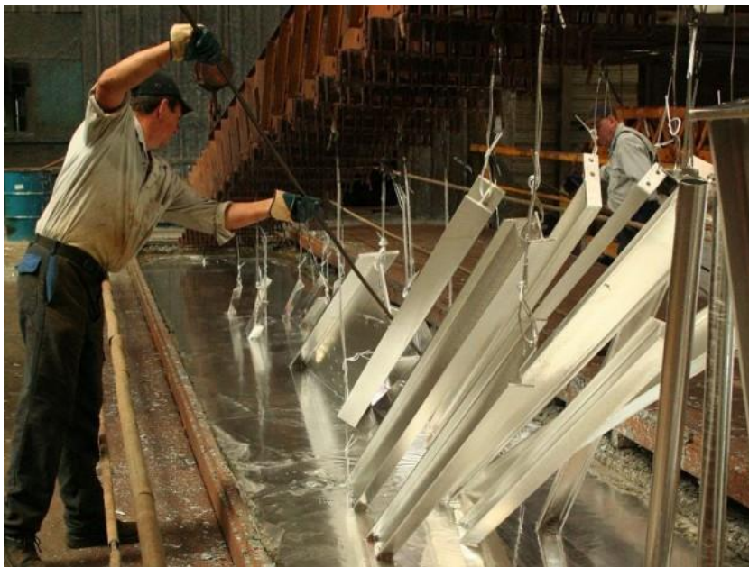
Slika 13 Primjer procesa galvanizacije čelika. Izvor: https://www.batiactu.com/images/auto/620-465-c/20120620_161802_img0019.jpg
