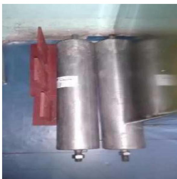
Slika 24 Primjer magnezijskih žrtvenih anoda kakve se često koriste pri katodnoj zaštiti vodenih komora kondenzatora. Izvor: Ashwini, K. (2016.) "Applications of Cathodic Protection Systems for Power Plant Components"
