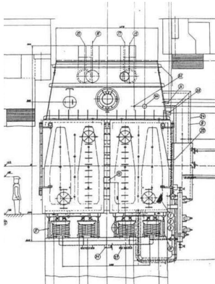
Slika 26 Nacrt kondenzatora Izvor:Tehnički opis površinskog kondenzatora TE "Plomin"
