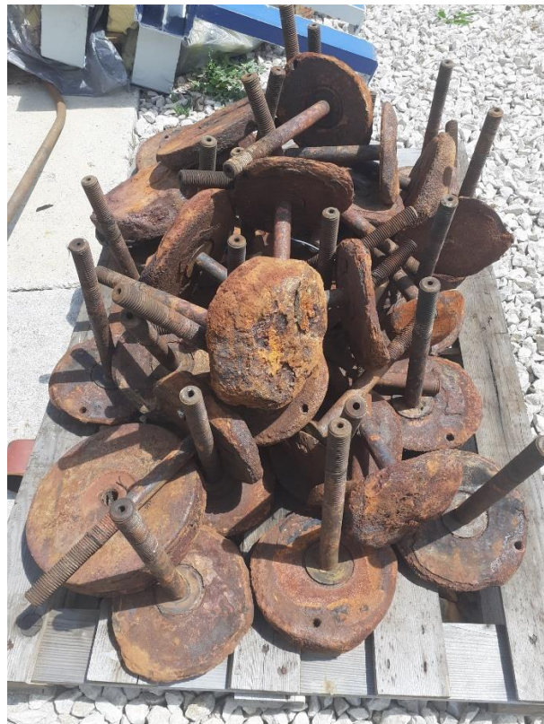
Slika 28 Slika potrošenih željeznih anoda nakon korištenja. Izvor: Autorska slika
