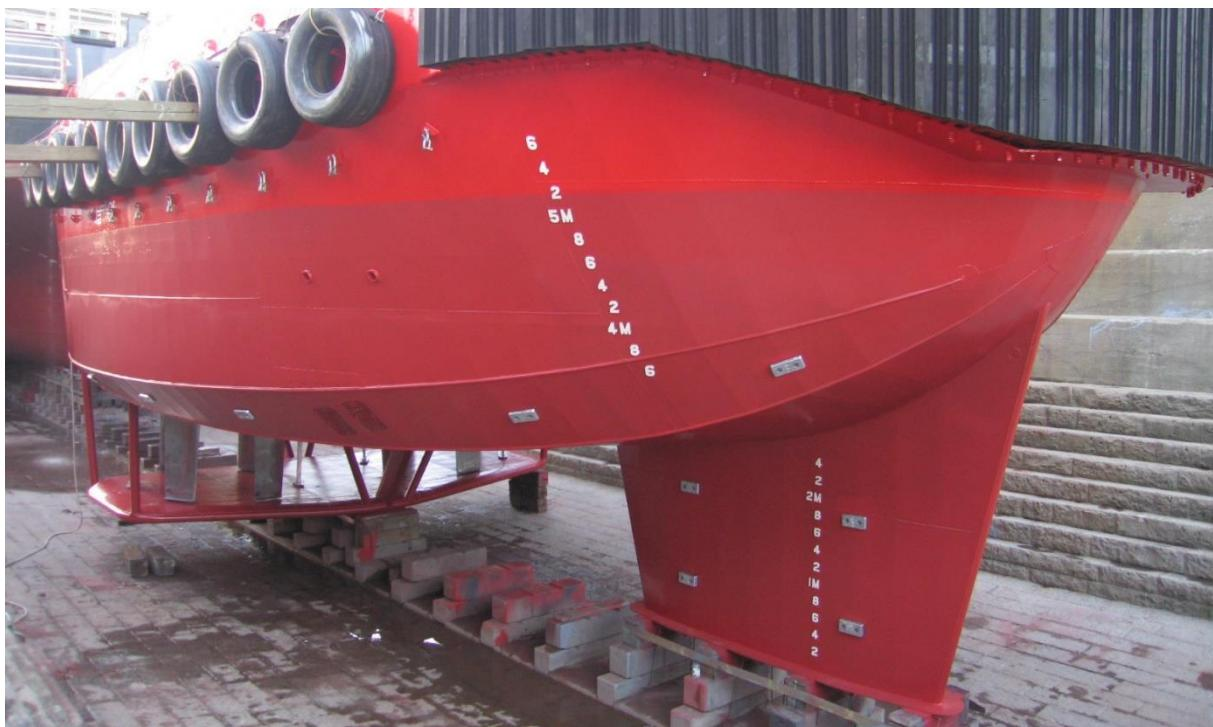
Slika 18 Primjer sustava pasivne katodne zaštite na brodu. Vidljive su brojne žrtvene anode na trupu broda. Izvor: <https://korrosionsgruppen.se/wp-content/uploads/2019/11/Hull-Anodes.jpg>
