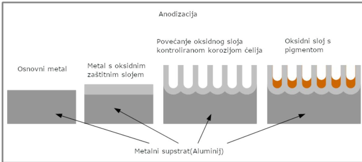
Slika 10 Dijagramske prikaze procesa anodiziranja aluminija na mikro razini. Izvor: Obrada autora prema <https://www.substech.com/dokuwiki/lib/exe/fetch.php?w=&h=&cache=cache&media=anodizing.png>
