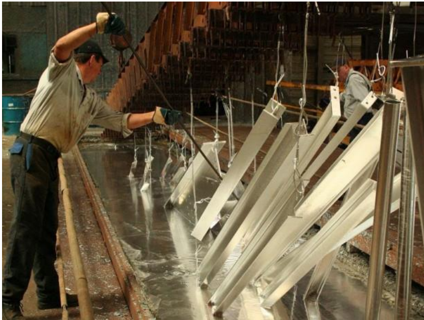
Slika 13 Primjer procesa galvanizacije čelika. Izvor: https://www.batiactu.com/images/auto/620-465-c/20120620_161802_img0019.jpg
