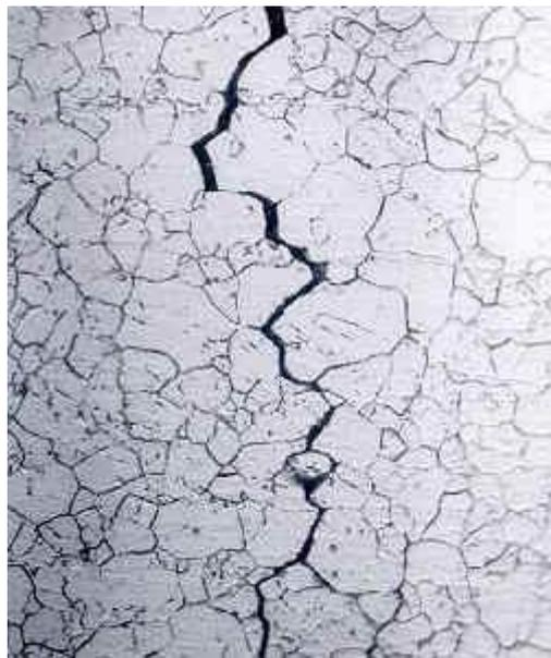
Slika 5 Mikroskopska slika pucanja pod korozivnim naprezanjem. Izvor:
