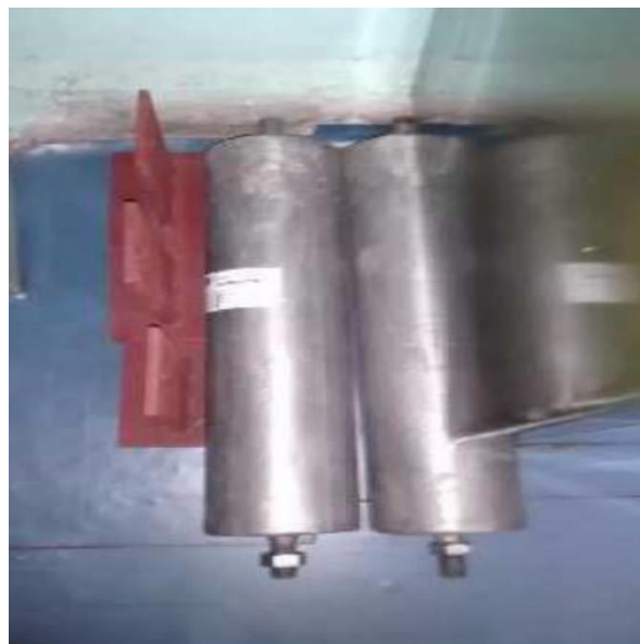
Slika 24 Primjer magnezijских žrtvenih anoda kakve se često koriste pri katodnoj zaštiti vodenih komora kondenzatora. Izvor: Ashwini, K. (2016.) "Applications of Cathodic Protection Systems for Power Plant Components"
