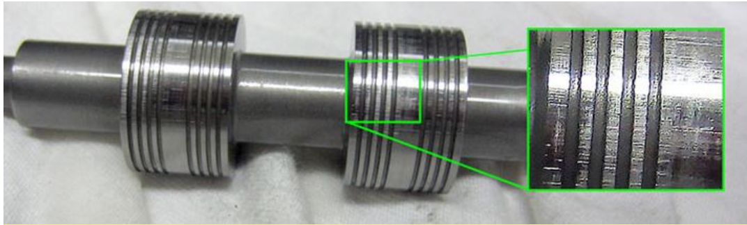
Slika 20 Prikaz oštećenja špule
