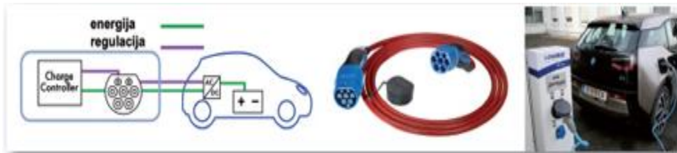
Slika 24 Punjenje izmjeničnom strujom
