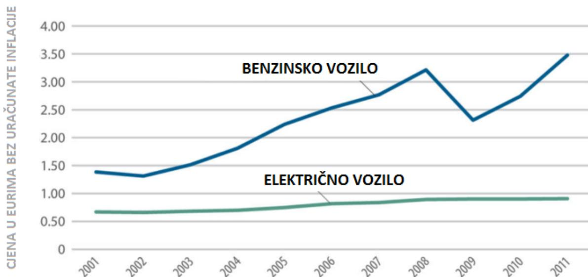
U obzir uzimamo 10 l/100km benzinskog automobila (prosječna efikasnost goriva) i električnog vozila efikasnosti 180 kWh/100km (Nissan Leaf).
