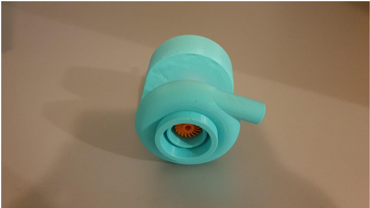
Slika 35 Fotografija gotovog 3D tiska pogled s strane kompresora
