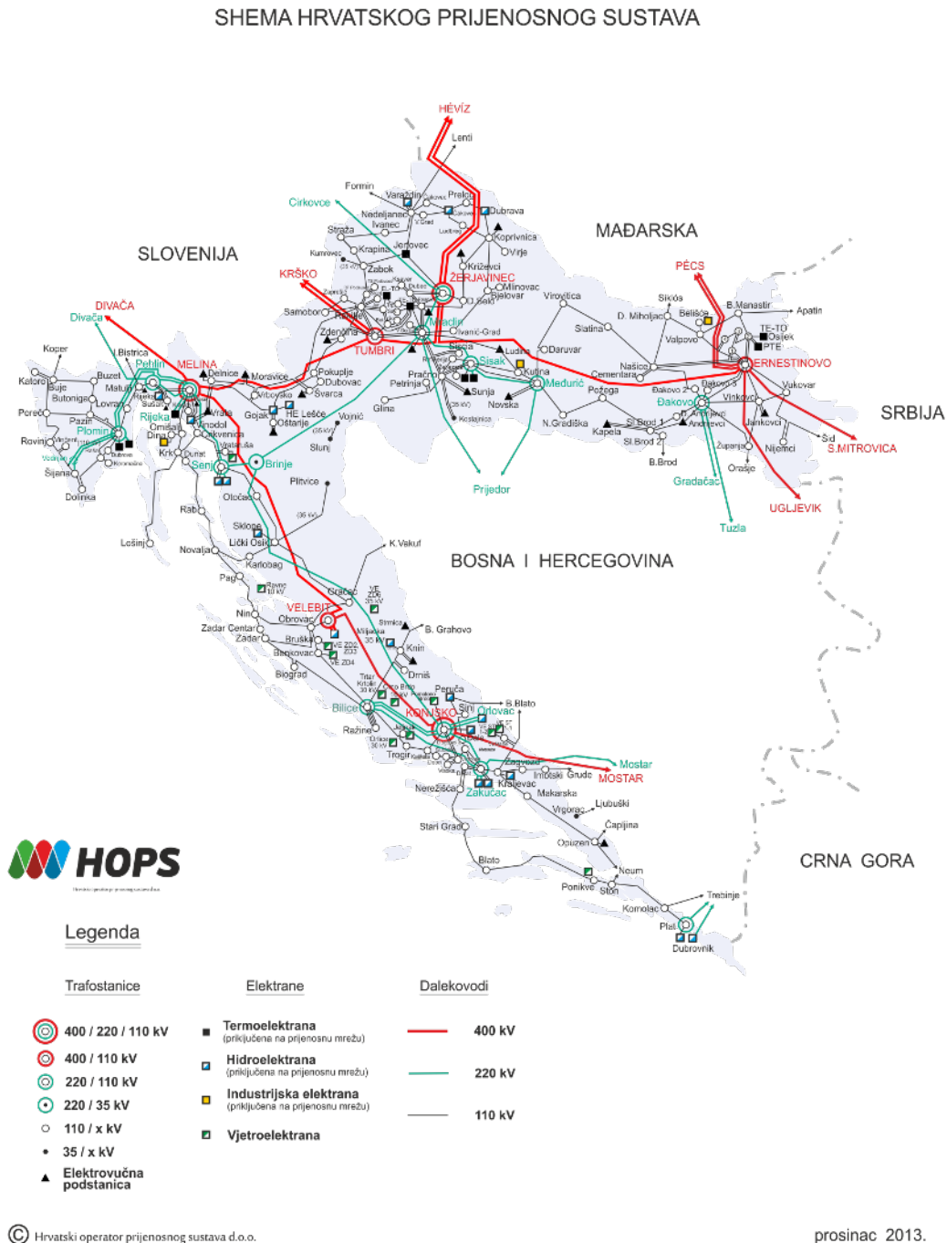
Slika 1. Shema prijenosnog sustava električne energije u Republici Hrvatskoj, izvor: https://www.hops.hr/wps/portal/hr/web/hees/podaci/shema
