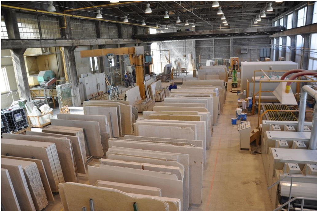
Slika 10: Početak linije za obradu gateriranih ploča
