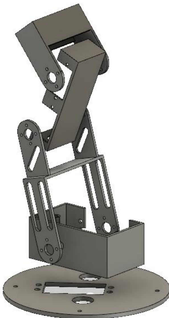
Slika 28: Rezultat 3D projektiranja robotske ruke Izvor: obrada autora
