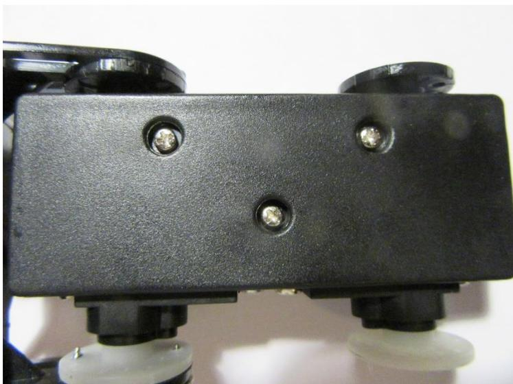
Slika 31: Kućište za dva servomotora
