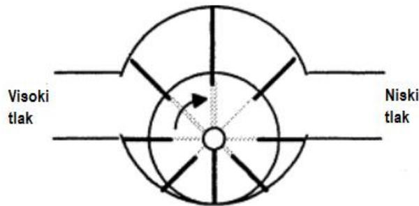
Slika 9: Princip rada hidrauličkog rotacijskog aktuatora sa lopaticama
