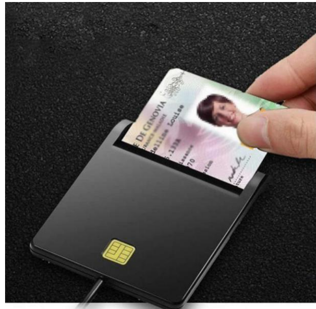
Slika 16. Prikazuje IOGEAR čitat smart card-a
