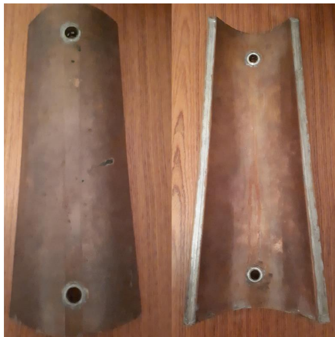
Slika 10 Prikaz prototipa crijepa
