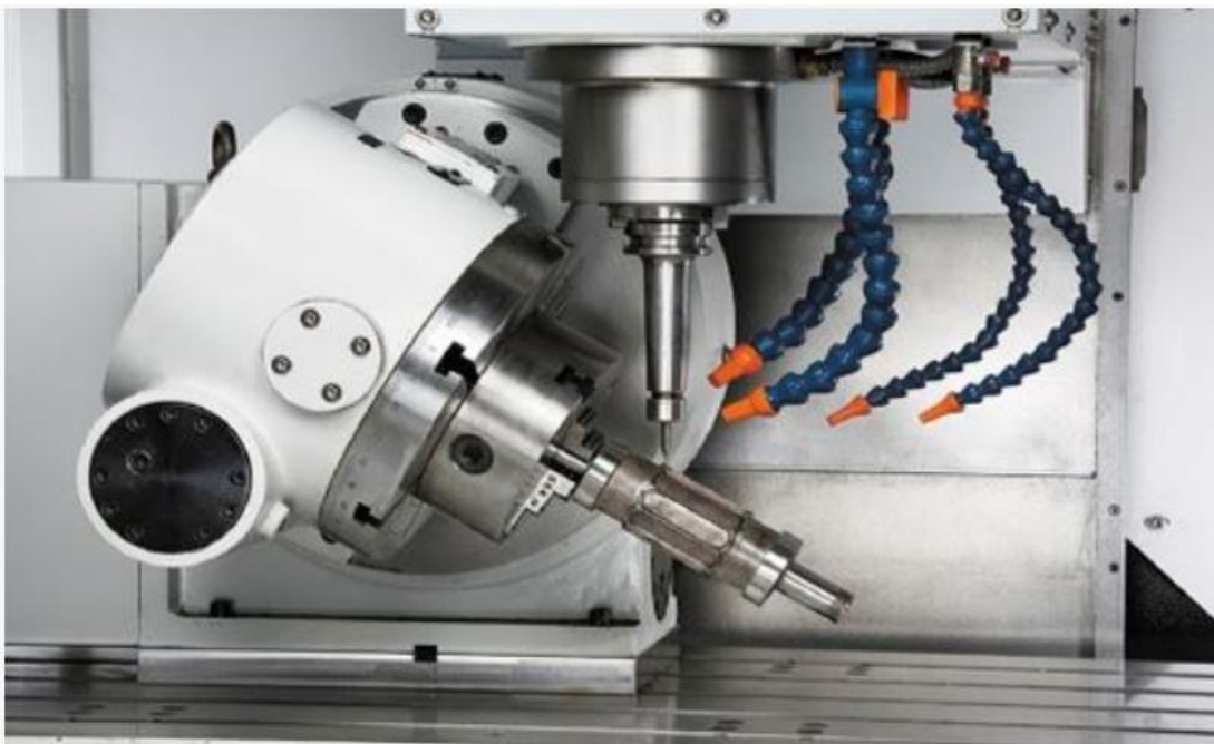
Slika 1 Prikaz obrade na pet osnoj glodalici
