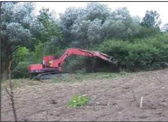
Slika 11: bager MVB 006 kao stroj za razminiranje (izvor: www.doking-razminiranje.hr )
