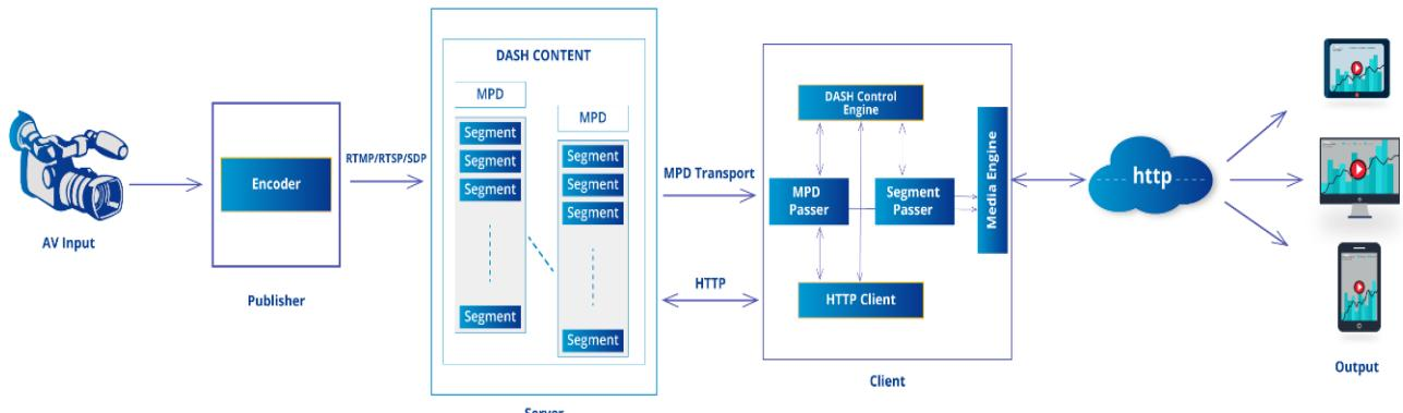
Slika 10:MPEG-ov dinamički prilagodljivi streaming preko HTTP-a (DASH)
