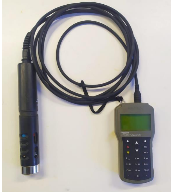
Slika 7. Višeparametarska sonda Hanna HI98194 kojom su se svakodnevno vršila mjerenja.
