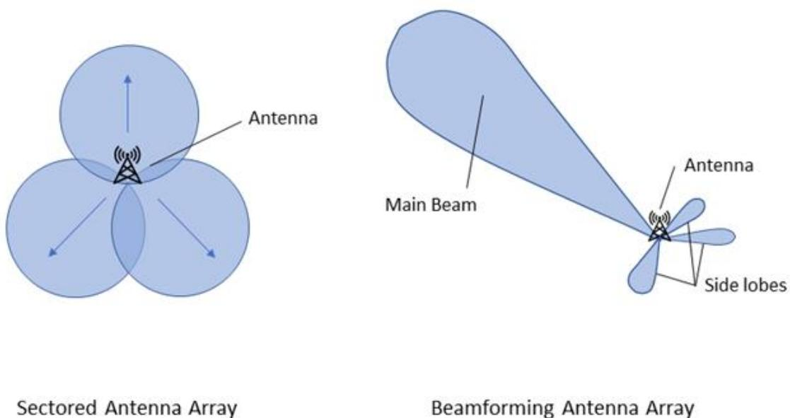
Slika 11 - Prikaz spajanja signala Beamformingom, preuzeto sa URL:
