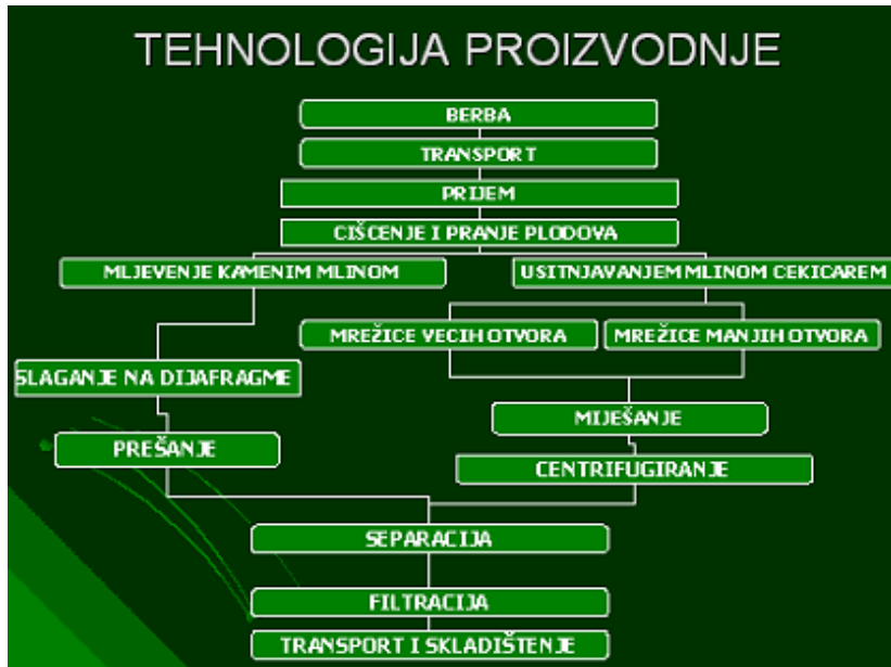
Slika 1: Proces proizvodnje maslinovog ulja.
