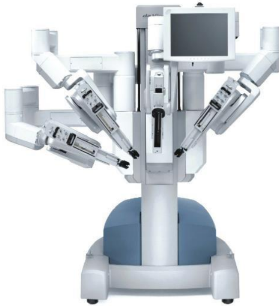
Slika 8. Robot Da Vinci, namijenjen za medicinske zahvate.
