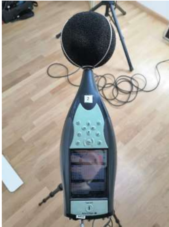
Slika 40. zvukomjer Brüel & Kjaer 2250
