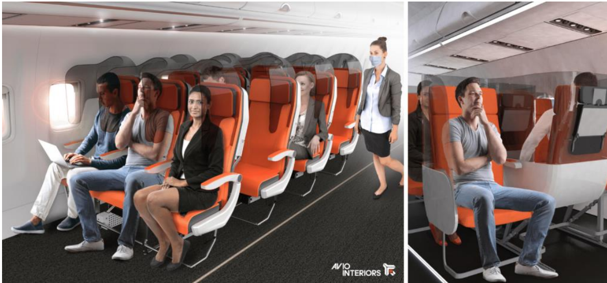
Slika 19. Sjedala projektirana za zaštitu od virusa
