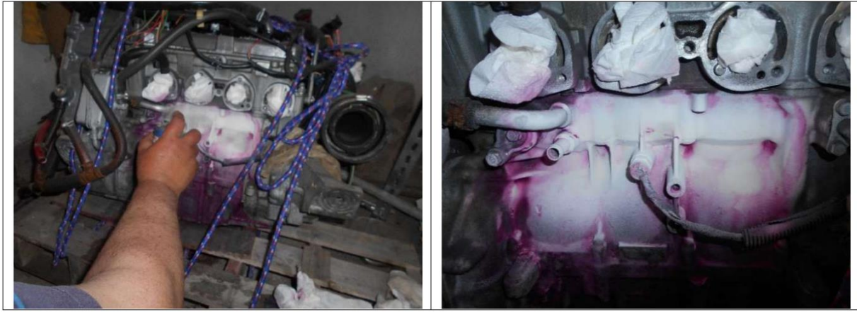
Slika 50. Nakon 5 minuta već su se otkrile dubinske pukotine kojih je ipak bilo manje nego se očekivalo
