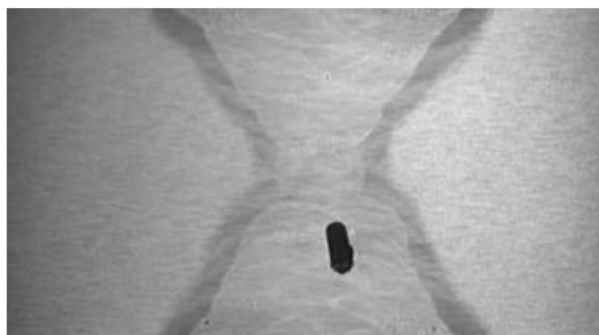
Slika 7. Uključina stranog metala
