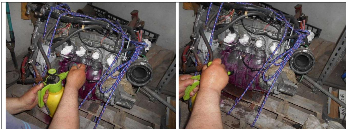
Slika 49. Nakon što se površina osušila, pristupilo se nanošenju bijelog razvijača (Izvor: obrada autorice)
