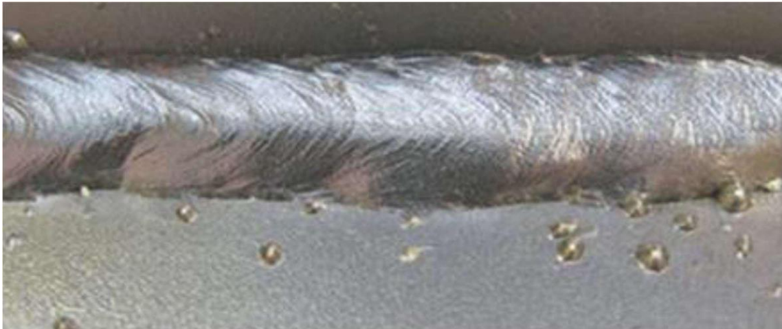
Slika 25. Onečišćenje raspršenim kapljicama metala
