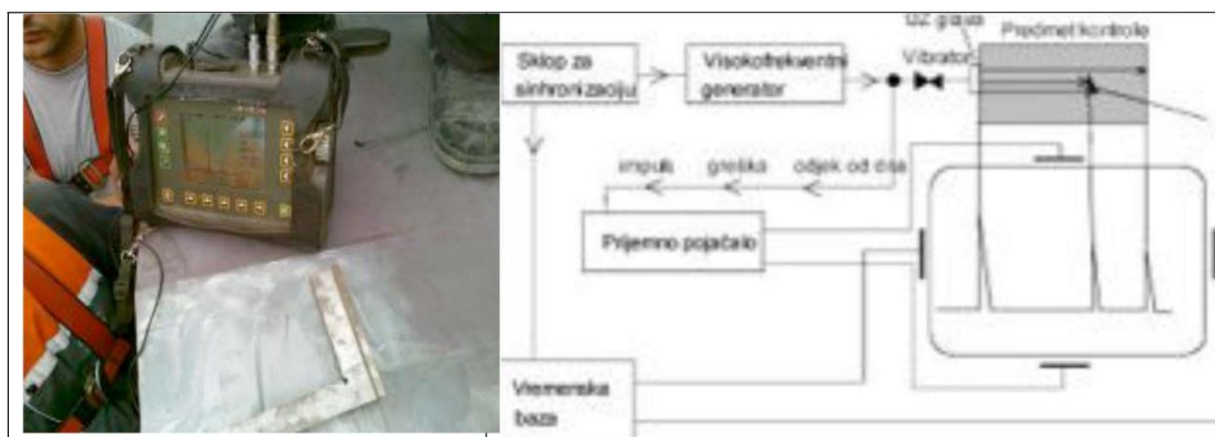
Slika 58. Primjer ultrazvučnog ispitivanja zavara 2/2 (Izvor: obrada autorice)
