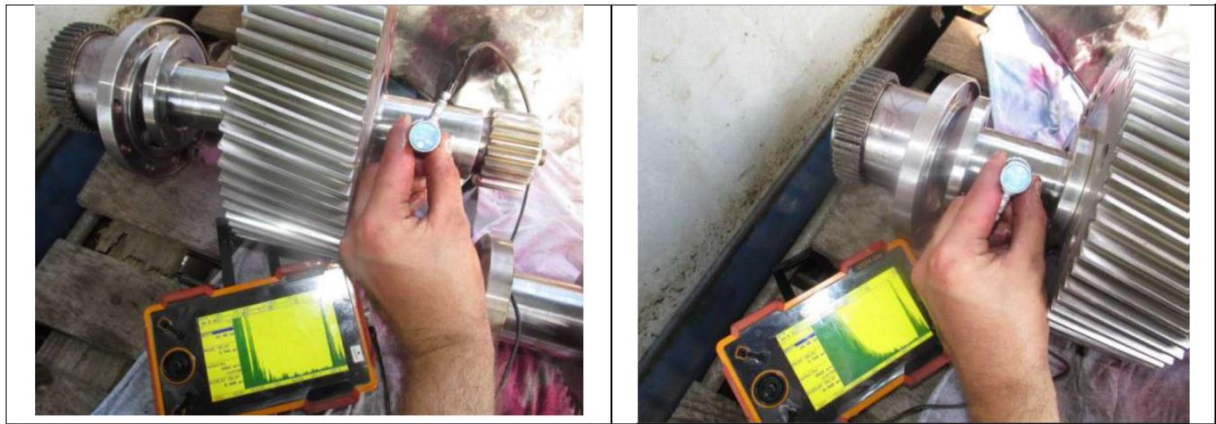
Slika 42. Ispitivanje ležajnih rukavaca kod pogonskog zupčanika
