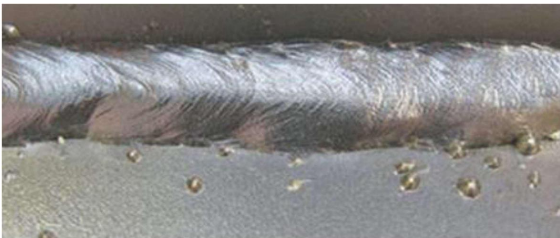
Slika 25. Onečišćenje raspršenim kapljicama metala
