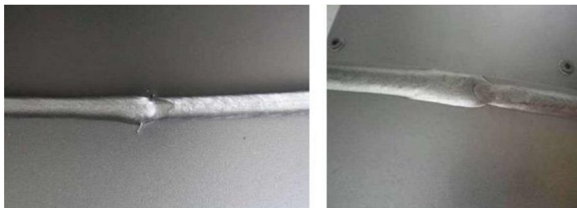
Slika 24. Nepravilno izveden nastavak zavar - (Izvor: www.twi-global.com )
