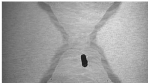
Slika 7. Uključina stranog metala
