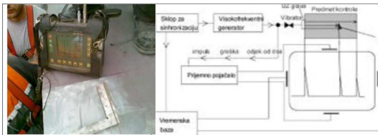
Slika 58. Primjer ultrazvučnog ispitivanja zavara 2/2 (Izvor: obrada autorice)
