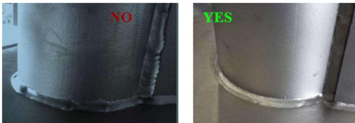
Slika 23. Neravnomjerna površina zavara (lijevo), te desno pravilnog zavara
