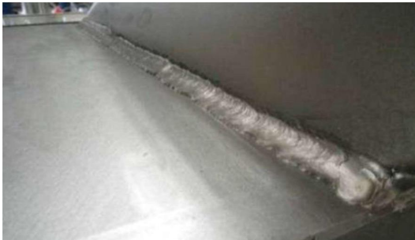
Slika 14. Primjer ugorina po cijeloj dužini zavora
