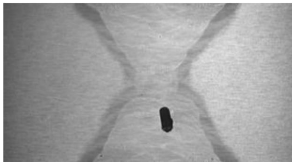
Slika 7. Uključina stranog metala
