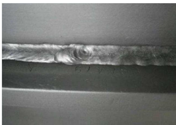
Slika 5. Šupljina ili poroznost u završnom krateru
