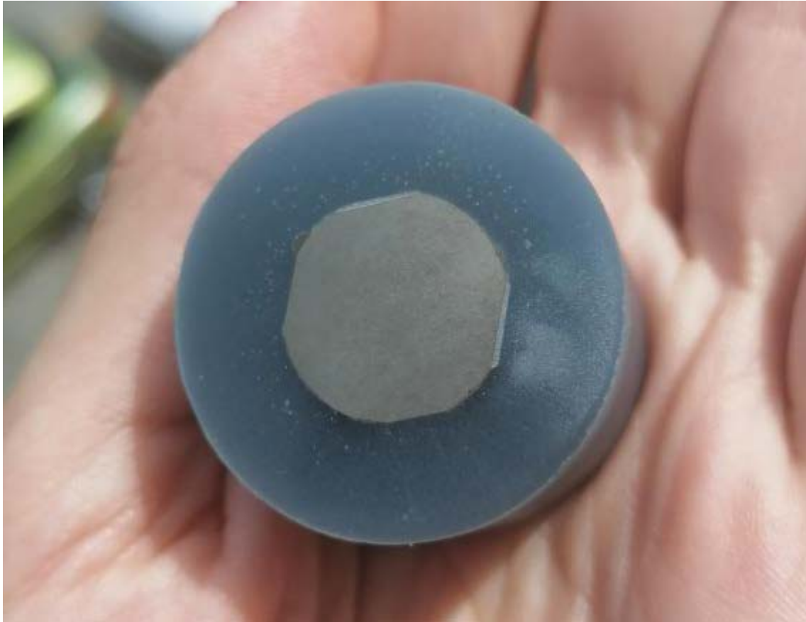
Slika 18 – Površina nagrizanog uzorka bez mikroskopa
