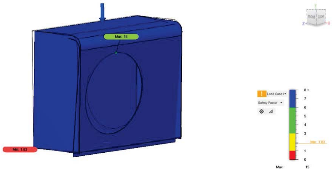
Slika 34. Rezultat FEM analize koji pokazuje najveći i najmanji sigurnosni faktor
