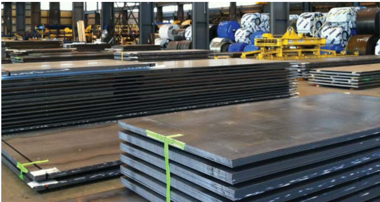
Slika 3. - ploče legure N.1.7227, AISI 4140
