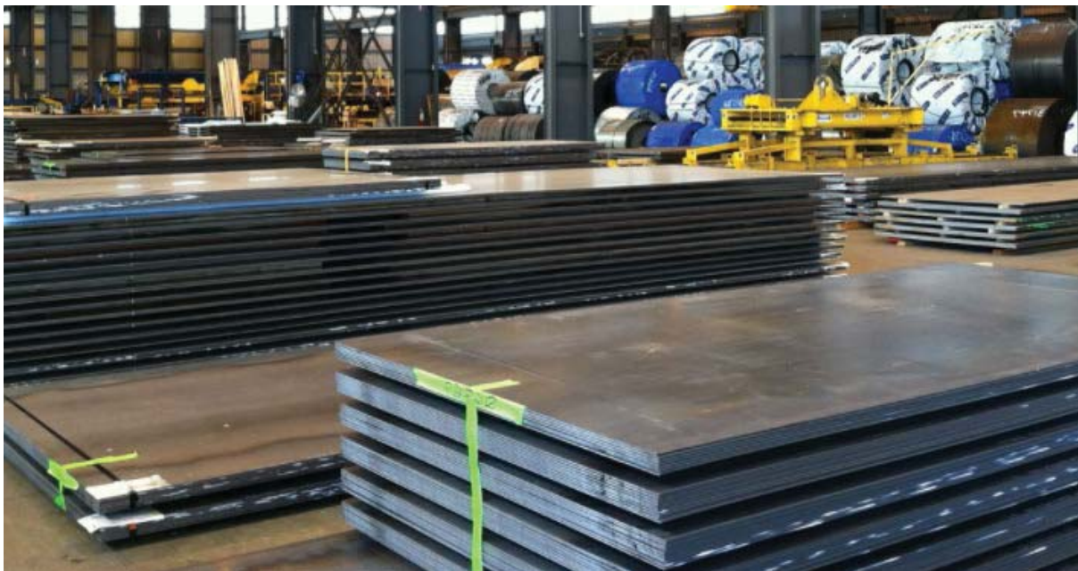
Slika 3. - ploče legure N.1.7227, AISI 4140
