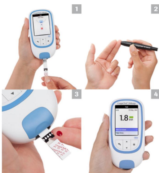
Slika 19. Prikaz korištenja CoaguCheck INRange uređaja.
