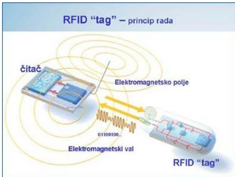
Slika 8: RFID tag - princip rada
